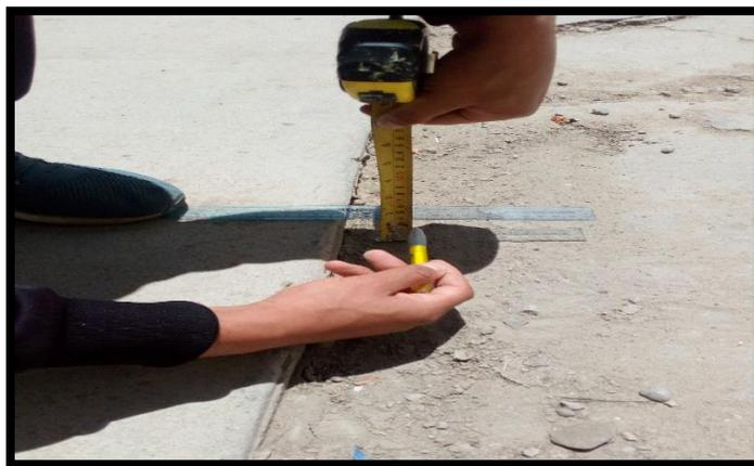
**Figura 80. Falla Escala de severidad leve - presentado en el Jr. Jaime de Martínez.**
