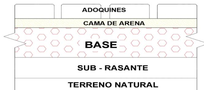
**Figura 3. Sección de pavimento articulado.**
