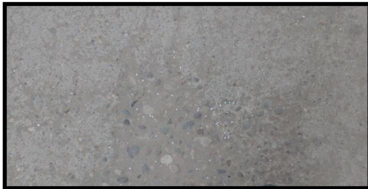
**Figura 75. Falla pulimiento de agregados -presentado en el Jr. Jaime de Martínez.**
