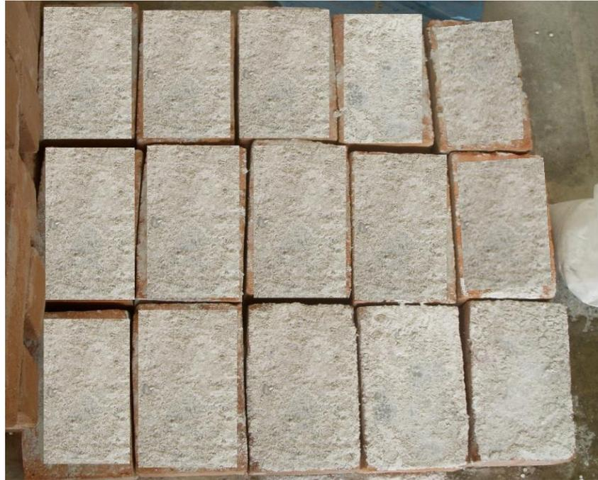
**Figura 23.** Ladrillos refrentados con yeso para prueba de resistencia a compresión.
