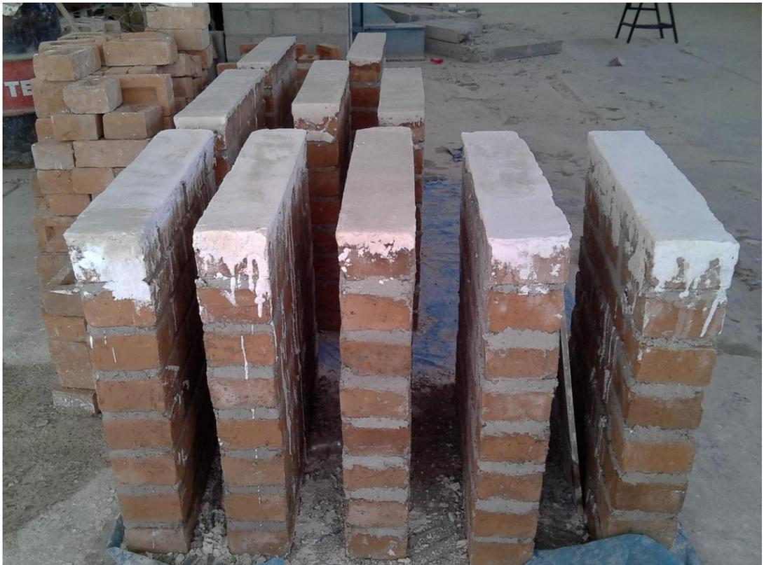
**Figura 39.** *Colocación de capping en muretes para prueba de Resistencia a compresión diagonal*
