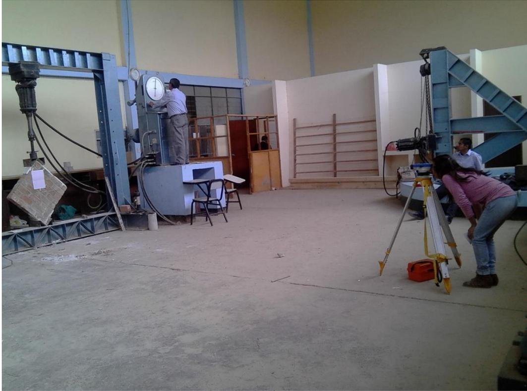
**Figura 40.** *Ensayo de Resistencia a compresión diagonal*
