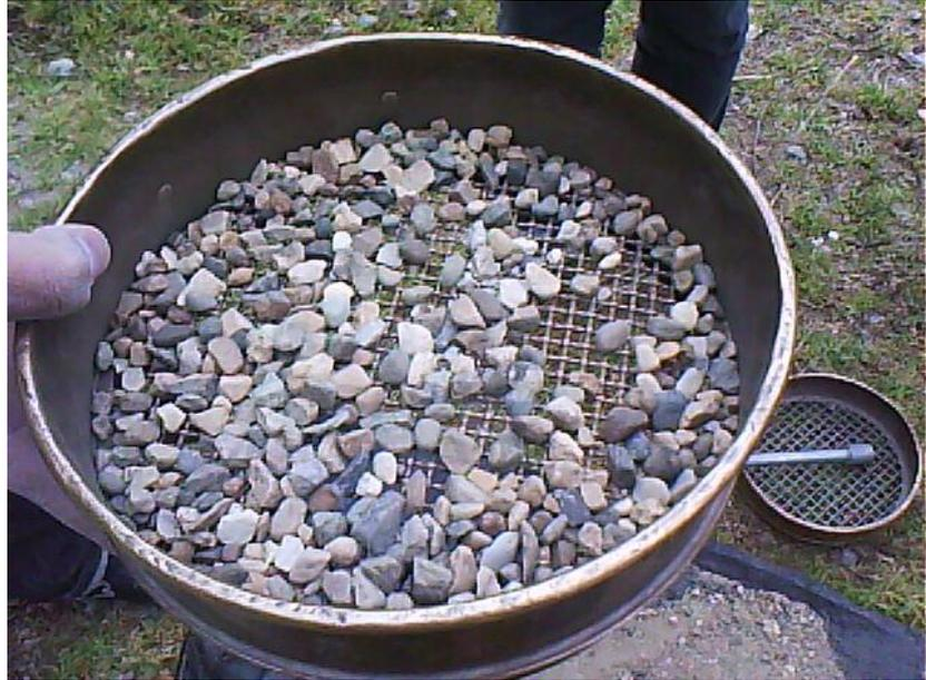
**Figura 21.** Análisis Granulométrico.
