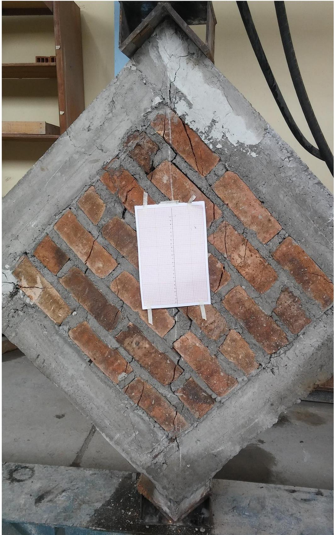
**Figura 48.** Falla de murete confinado sometido a carga de compresión diagonal
