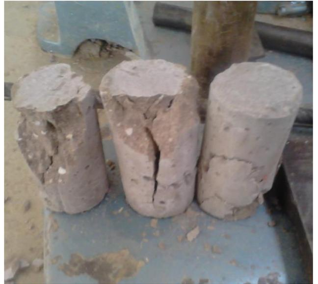
**Figura 44.** Ensayos de Resistencia a compresión de mortero
