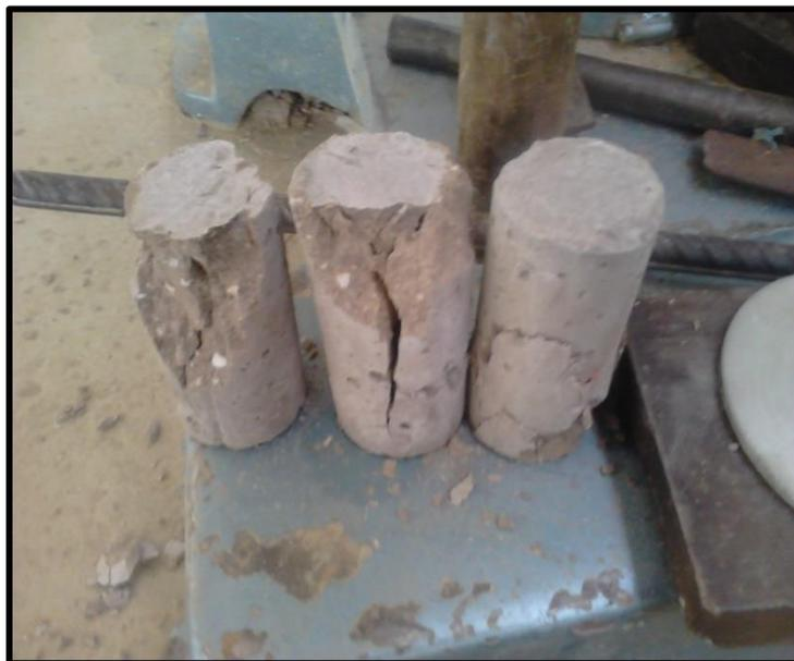
*Figura 30. Ensayo a compresión del mortero.*
