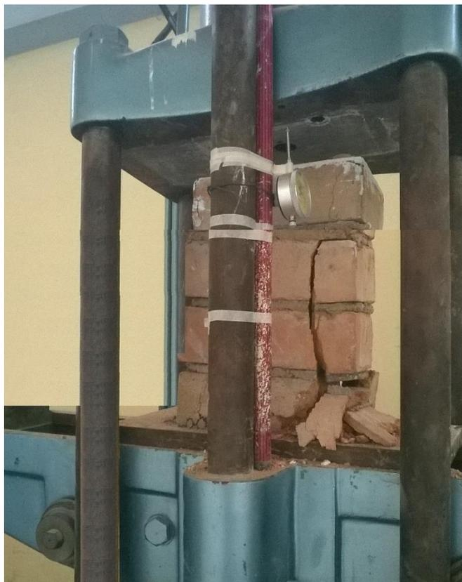
**Figura 37.** *Falla de carga a compresión de prismas*
