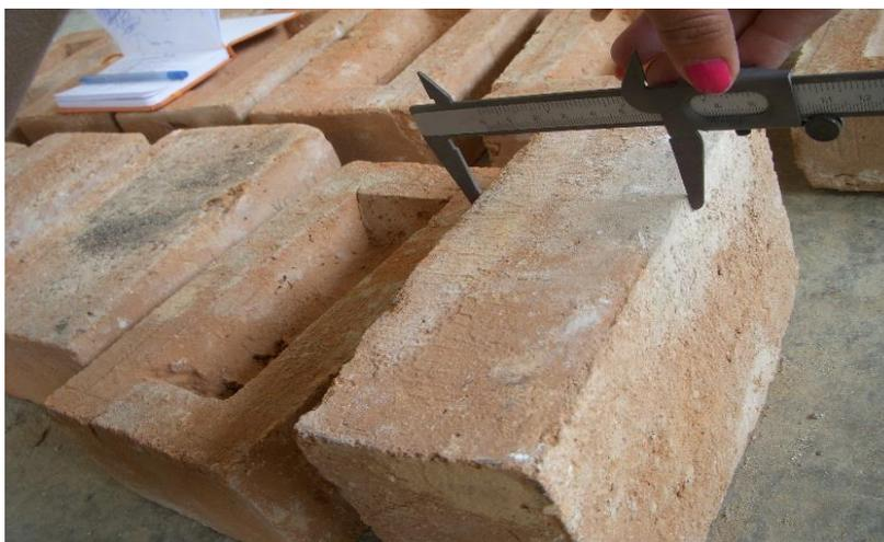
*Figura 22. Medida de ladrillo con vernier*
