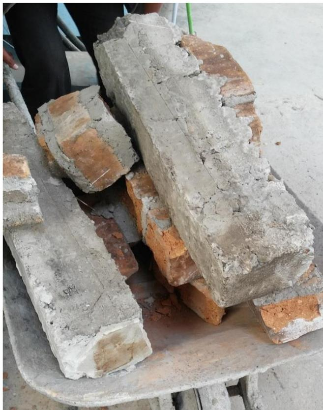
**Figura 50.** Falla de murete con confinamiento lateral, luego de ser sometido a carga de compresión diagonal
