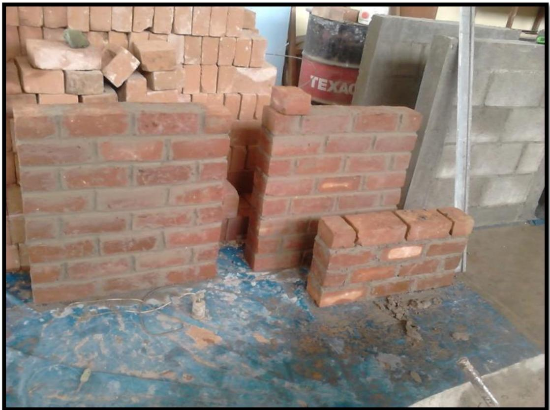
**Figura 24.** Prismas de Albañilería
