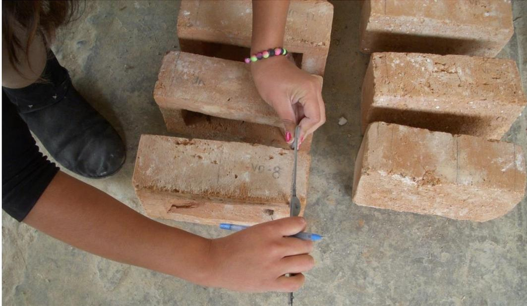
**Figura 34.** Toma de medidas para el Ensayo de variación dimensional
