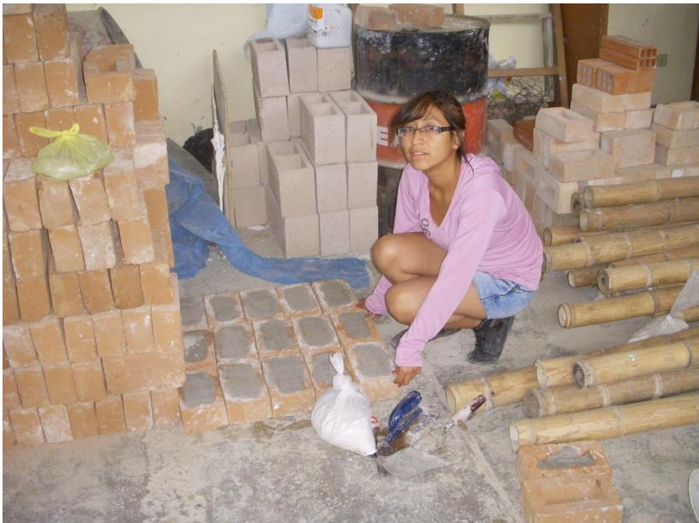
**Figura 35.** Colocación de capping para el ensayo de compresión de las unidades de albañilería
