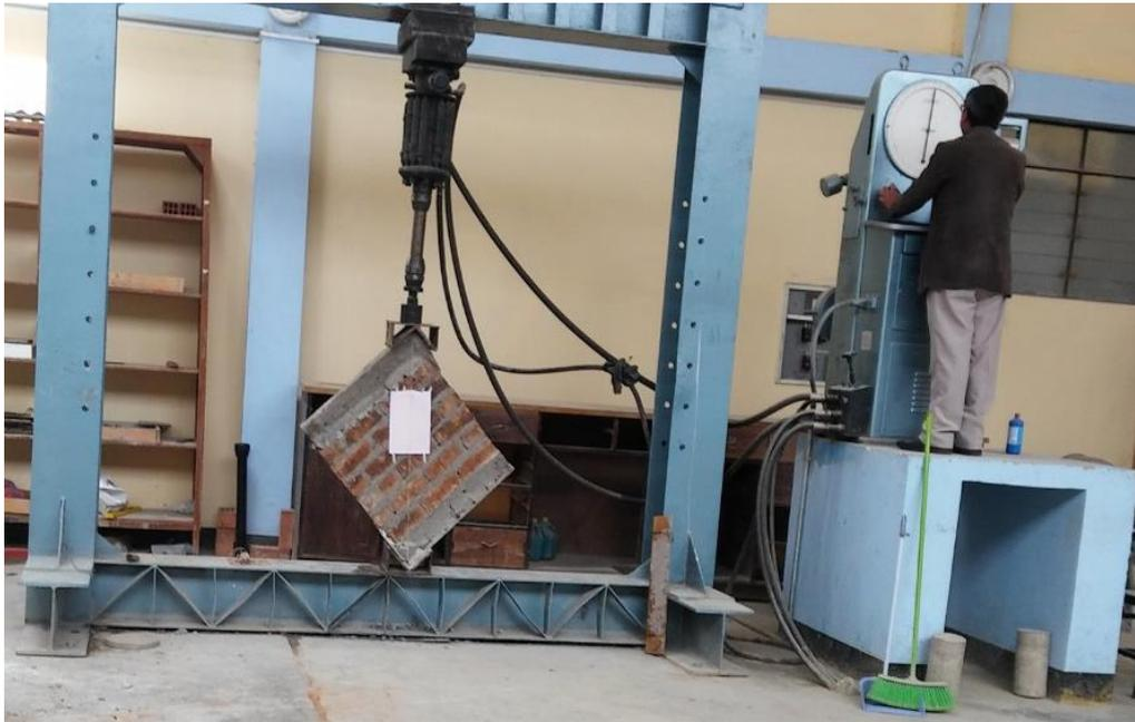
**Figura 49.** Ensayo a compresión diagonal de murete confinado lateralmente
