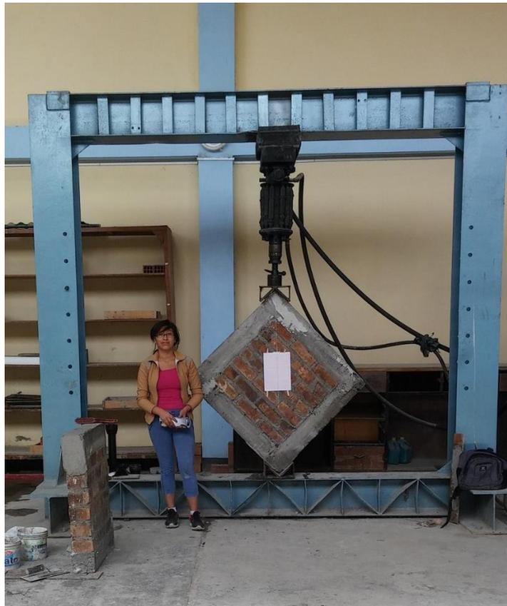
**Figura 47.** Ensayo de compresión axial en murete confinado
