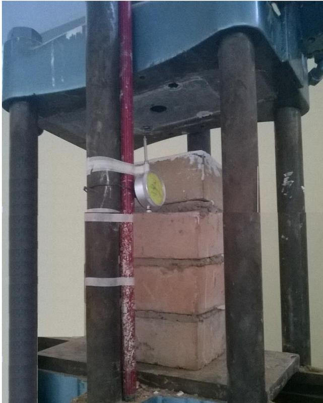
**Figura 36.** *Ensayo de resistencia a compresión de prismas*
