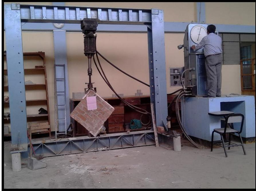
**Figura 29.** Máquina universal para ensayo de muretes
