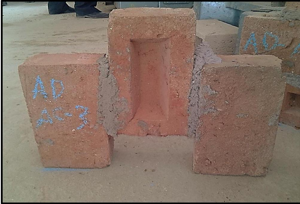
**Figura 31.** Especímenes para el ensayo al corte de mortero
