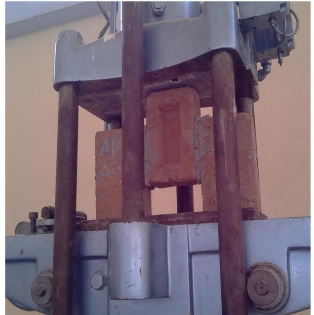
**Figura 42.** *Ensayo de tripletes para adherencia del mortero*
