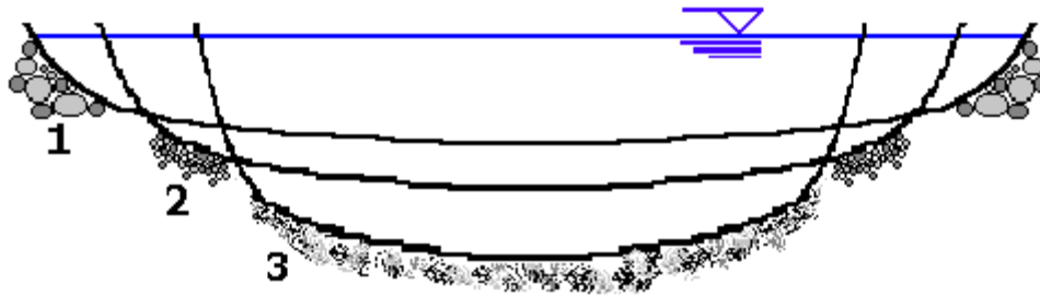
Figura N° 3: Formas de sección transversal con material grueso (1), medio (2) y fino (3) si se conservan iguales las restantes condiciones
