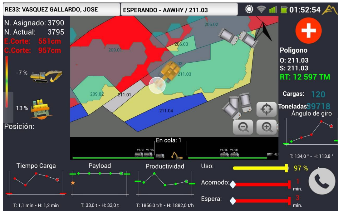
Figura N° 20: Pantalla de un equipo de carguío con sistema Control Sense (Mine Sense, 2017)
