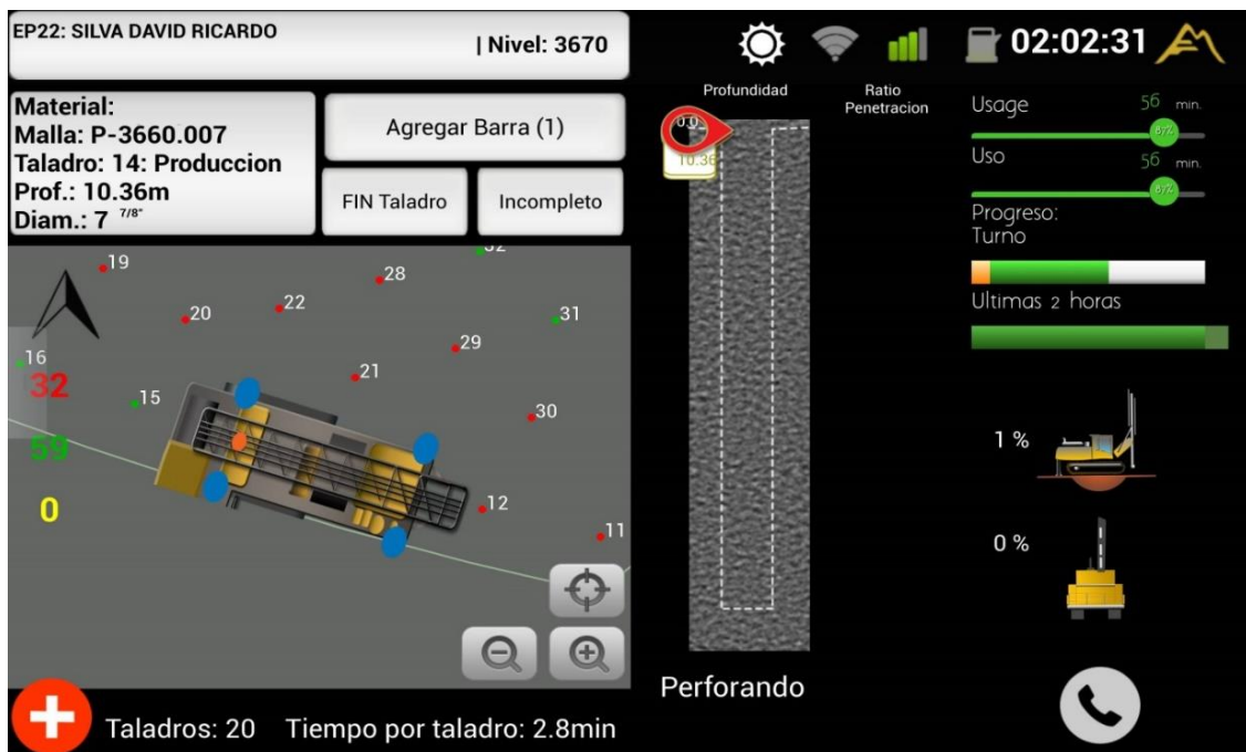
Figura N° 22: Pantalla de un equipo de perforación con sistema Control Sense (Mine Sense, 2017)
