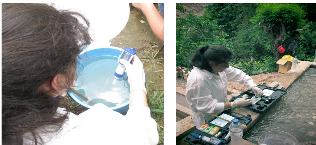
Figura 23. Medición de pH, temperatura, sólidos suspendidos totales (SDT), conductividad eléctrica, salinidad y turbiedad de las muestras agua
