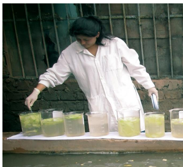
Figura 24. Agregado de tejido vegetal a cada vaso de precipitación y agitado por cuatro minutos
