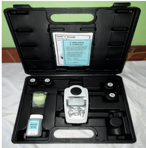
Figura 28. Turbidímetro utilizado para medir en campo la turbiedad de las muestras tratadas con los cactus Armatocereus rauhii subsp. Balsasensis R. y del cactus Espostoa mirabilis R.
