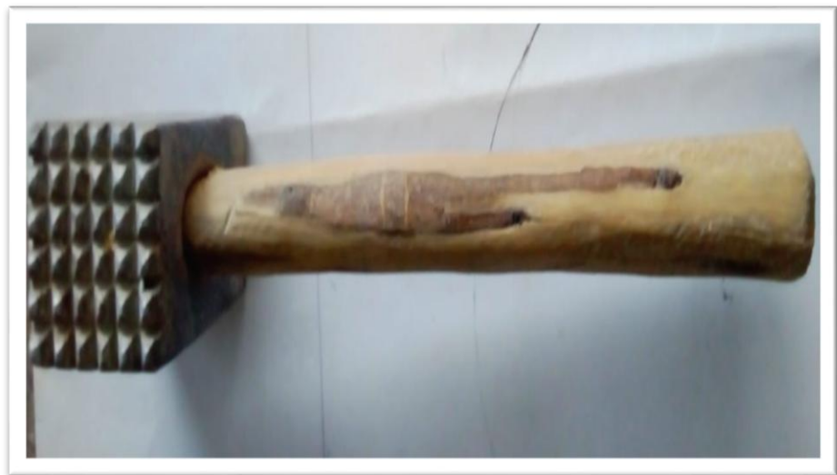
Fotografía 4 Herramientas para tallar la piedra: Bujarda
