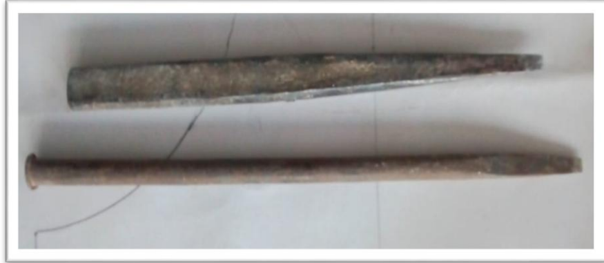
Fotografía 5 Herramientas para tallar la piedra: Puntas
