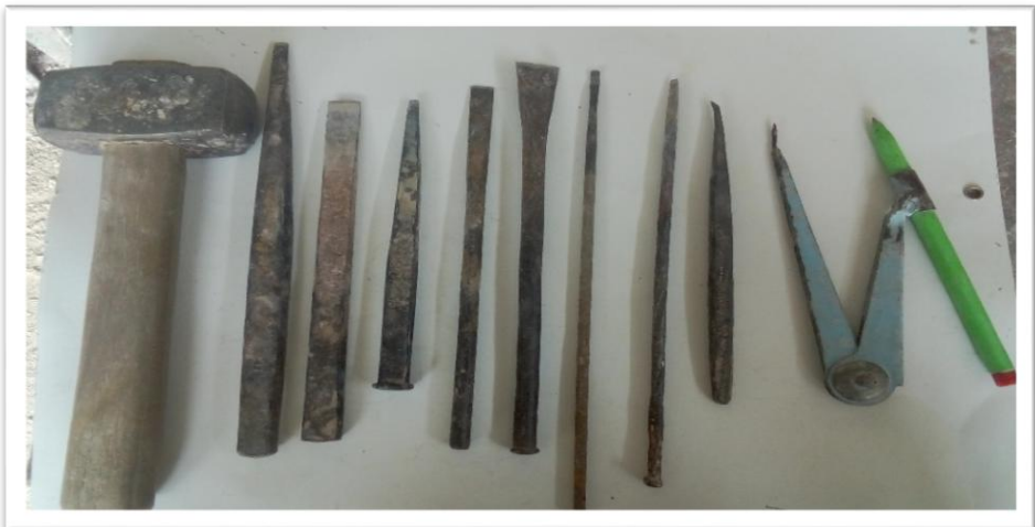
Fotografía 21 Herramientas utilizadas actualmente para tallar la piedra
