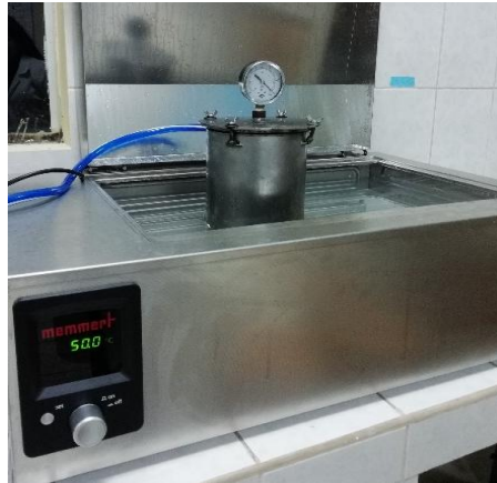
Figura 6. Equipo acondicionado para la deshidratación osmótica de las rodajas de yacón
