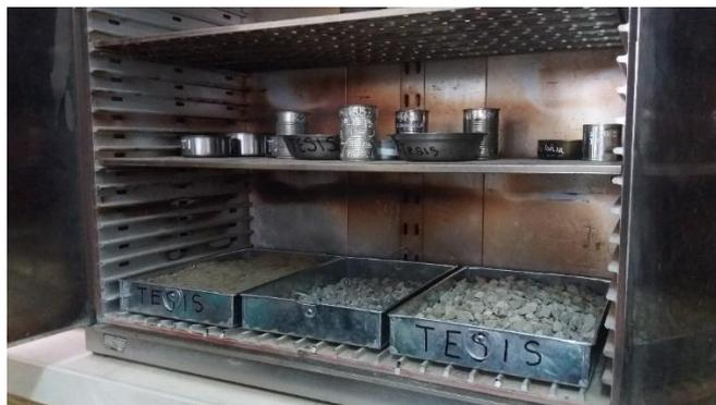
**Figura 7.3.** Ensayo de contenido de humedad.
