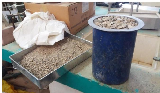
**Figura 7.12.** Peso unitario suelto del agregado grueso.
