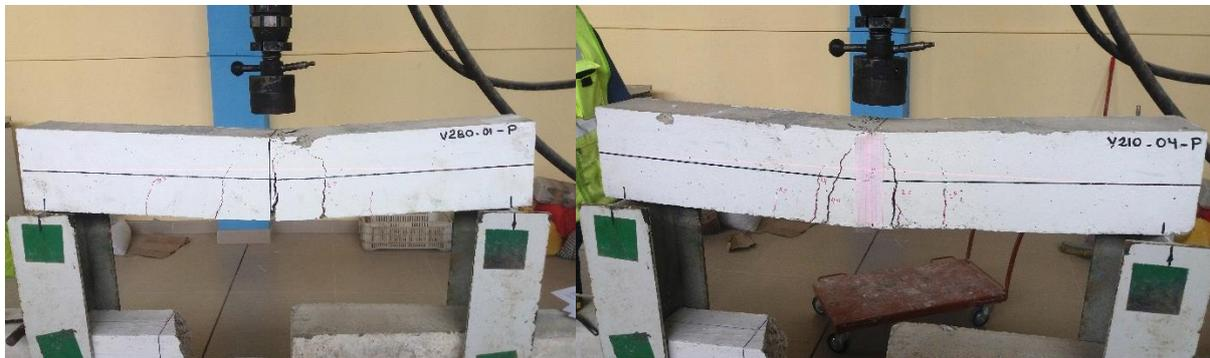
**Figura 7.41.** Ensayo a flexión de vigas patrón (210-280kg/cm<sup>2</sup>)
