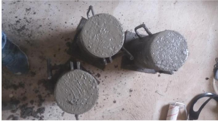
**Figura 7.28.** Elaboración de probetas cilíndricas
