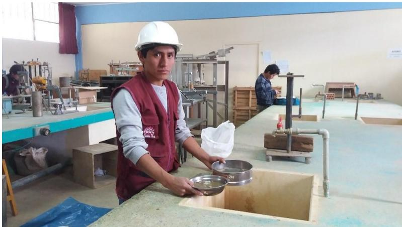
**Figura 7.14.** *Ensayo de porcentaje de finos que pasan el tamiz N°200.*
