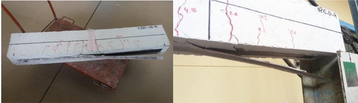
**Figura 7.43.** Fallas en las vigas reforzadas con láminas de Sika CarboDur S512.
