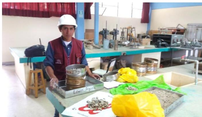
**Figura 7.4.** Ensayo de análisis granulométrico de agregados.
