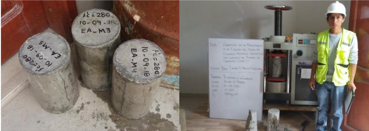
**Figura 7.19.** Ensayo a compresión de probetas de concreto a los 14 días ( $f'c=280\text{kg/cm}^2$ )
