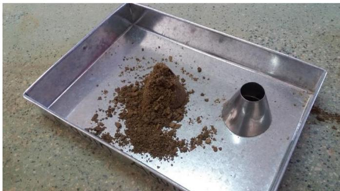
**Figura 7.8.** Agregado fino en estado de saturado con superficie seca.
