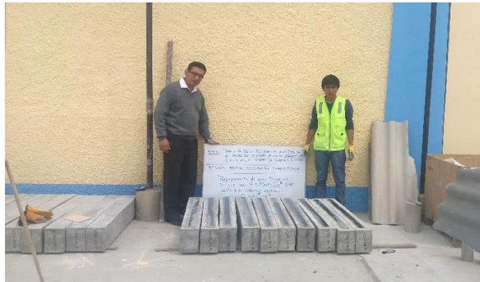
**Figura 7.38.** Reforzamiento a 10 vigas con Sika CarboDur S512.
