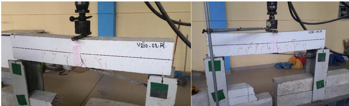
**Figura 7.42.** Ensayo a flexión de vigas reforzadas con láminas de Sika CarboDur S512 (210-280kg/cm<sup>2</sup>)
