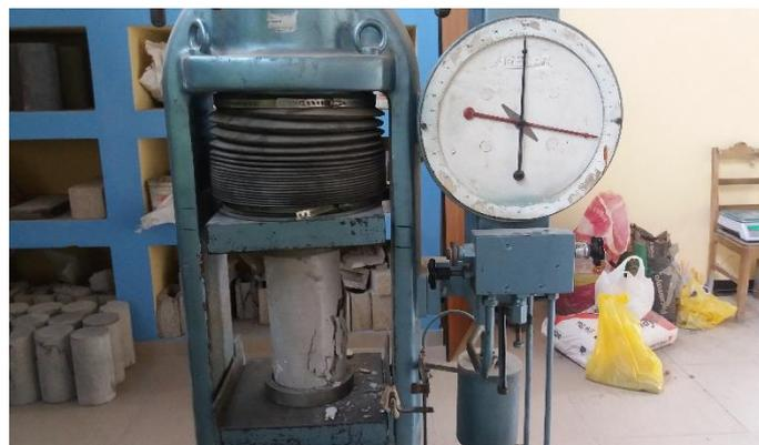
**Figura 7.39.** Ensayo a compresión de probetas de concreto.
