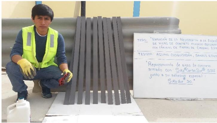
**Figura 7.32.** Reforzamiento con Sika CarboDur S512.
