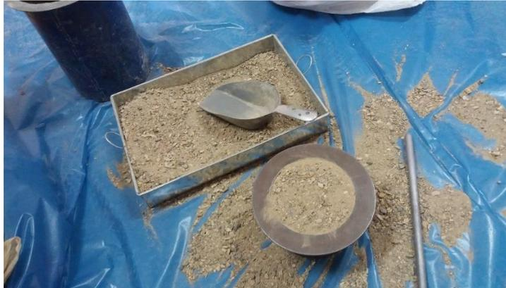
**Figura 7.11.** Peso unitario suelto compactado del agregado fino.
