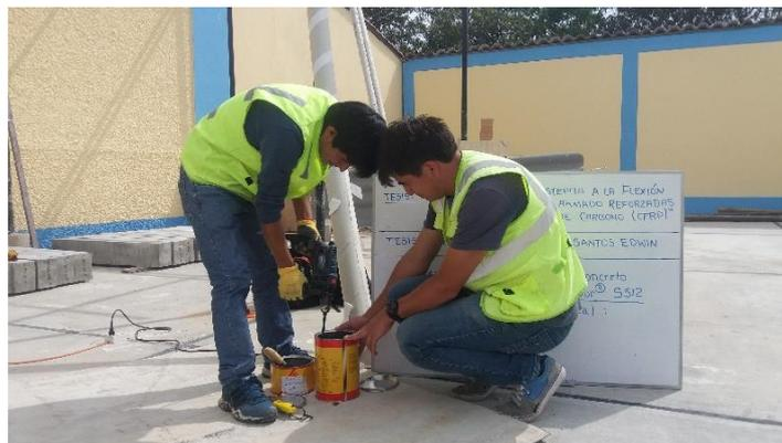
**Figura 7.34.** Mezclado del componente A y B del adhesivo Sikadur-30.
