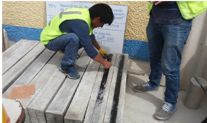
**Figura 7.37.** Pegado de las láminas de Sika CarboDur S512 a las vigas.
