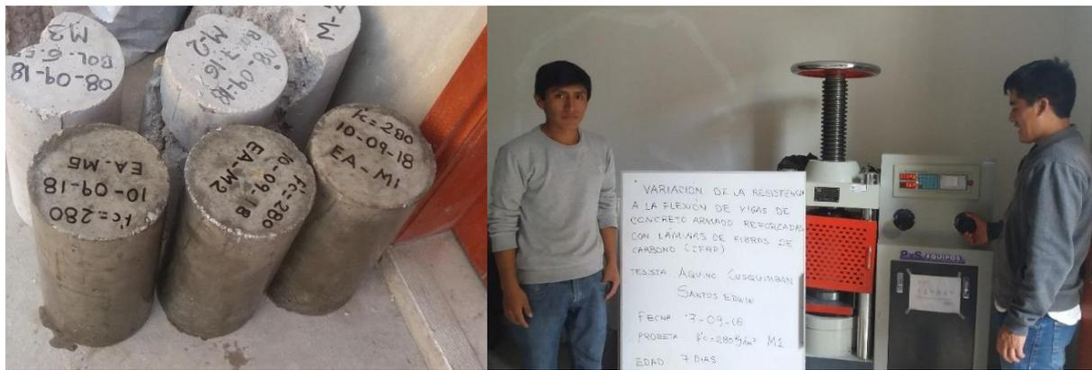
**Figura 7.17.** Ensayo a compresión de probetas de concreto a los 7 días ( $f'c=280\text{kg/cm}^2$ ).
