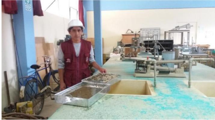
**Figura 7.5.** Saturación por 24 horas del agregado fino y del agregado grueso.
