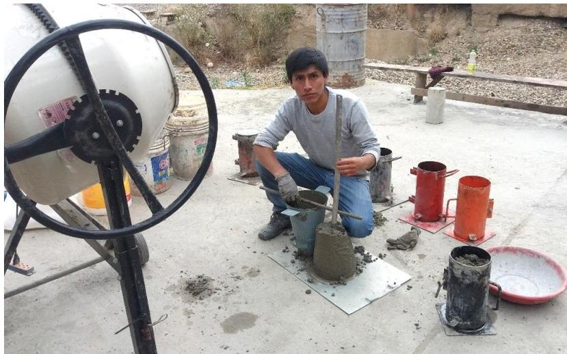
**Figura 7.15.** *Diseño de mezcla, ensayo de asentamiento del concreto y elaboración de probetas cilíndricas.*
