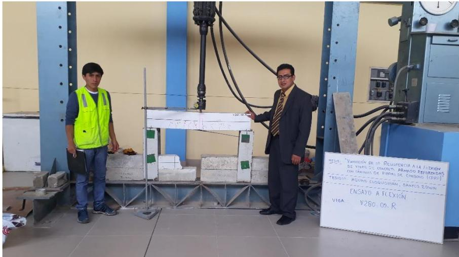
**Figura 7.44.** Ensayo a flexión de vigas reforzadas con láminas de Sika CarboDur S512.
