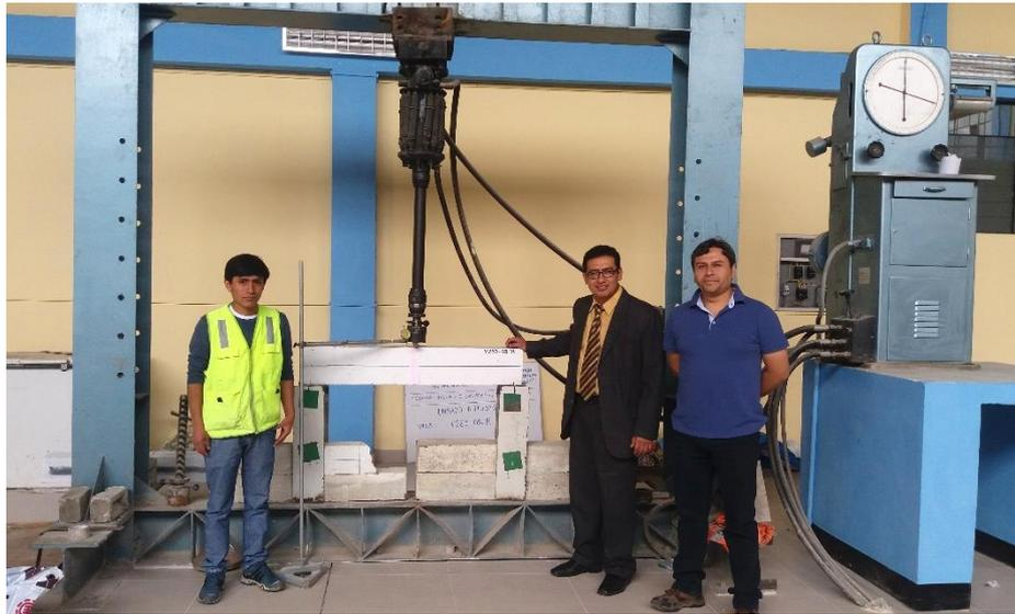
**Figura 7.40.** Inspección del Ing. Miguel Mosqueira en el ensayo a flexión de las vigas de concreto armado.
