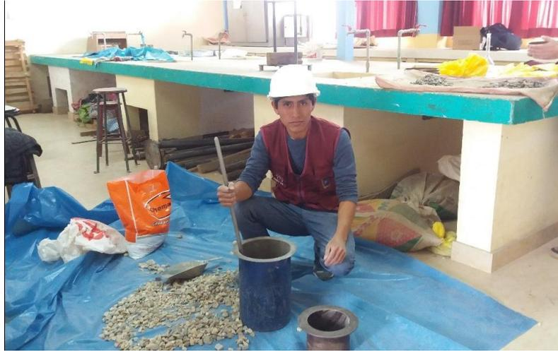
**Figura 7.13.** *Peso unitario suelto compactado del agregado grueso.*
