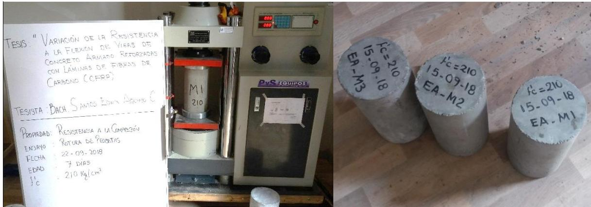
**Figura 7.16.** Ensayo a compresión de probetas de concreto a los 7 días ( $f'c=210\text{kg/cm}^2$ ).
