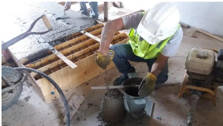
**Figura 7.27.** Ensayo de asentamiento del concreto.
