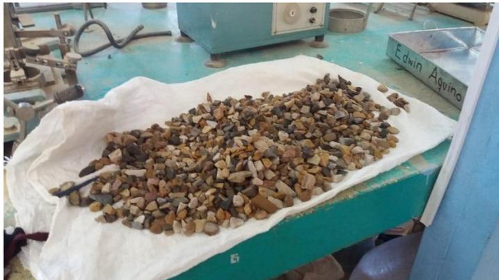
**Figura 7.6.** Agregado grueso en estado de saturado con superficie seca.
