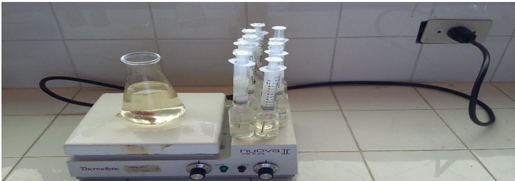
Figura 25. Para preparar un litro de medio de cultivo, primero se agrega 250 mL de agua destilada, mientras se agita, añadir el producto en polvo M.S.: 4,33 g·L -1 , sacarosa: 30 g·L -1 , agar: 6 g·L -1 , auxinas y citocininas de acuerdo los tratamientos; disuelto los productos, se debe enraazar a un litro, ajustando el pH a 5,7 con NaOH y HCl antes de agregar el agar. Luego se calienta la solución hasta la claridad el agar, por último, dispensar el medio de cultivo en recipientes, luego colocar en autoclave a una temperatura de 121 °C o 15 psi, durante al menos 15 minutos.
