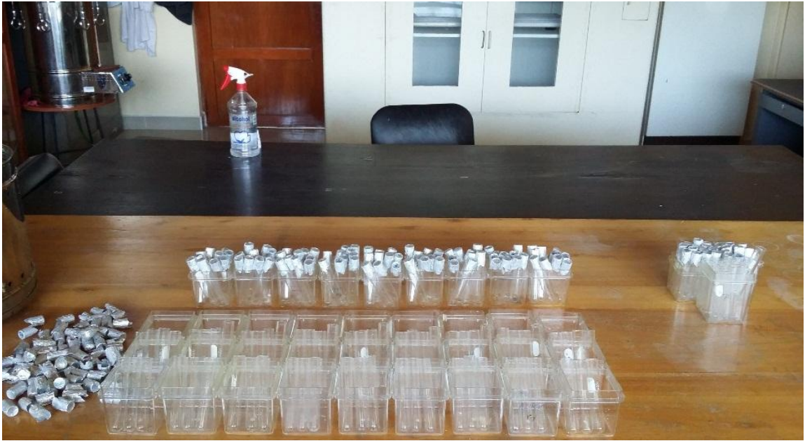
Figura 26. Magentas conteniendo tubos de ensayo de los tratamientos. Las tapas de aluminio que se encuentran en la parte inferior izquierda de la foto, tienen que estar pre fabricadas, para ahorrar tiempo en el trabajo y guardadas en un envase.
