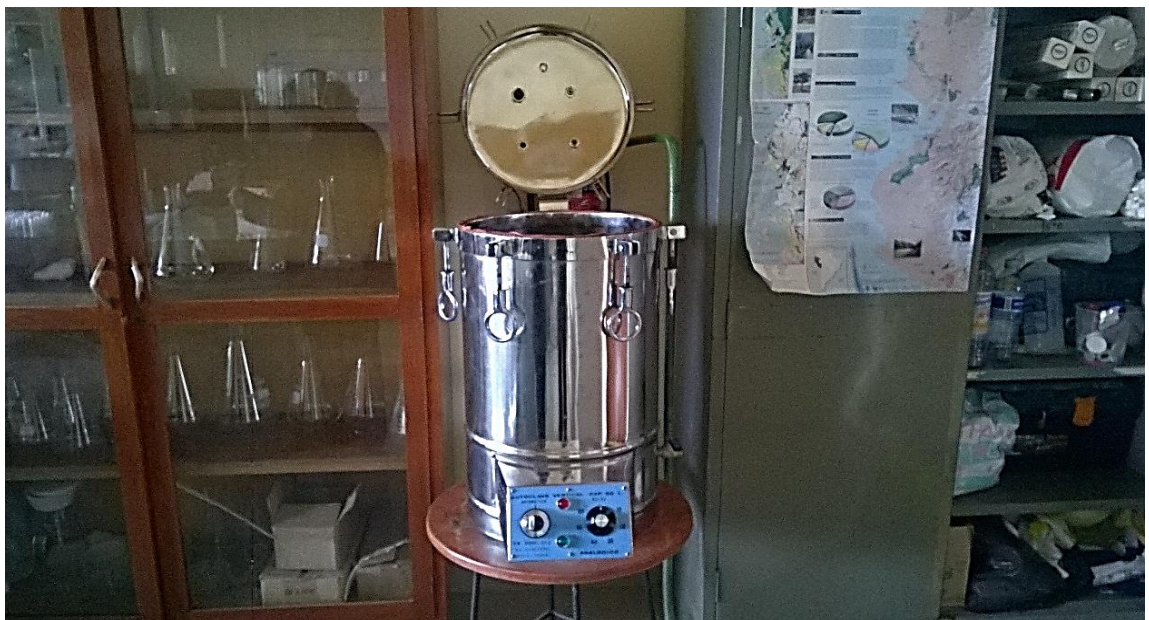
Figura 27. Autoclave, el cual sirve para la esterilización de materiales y de los medios de cultivo.
