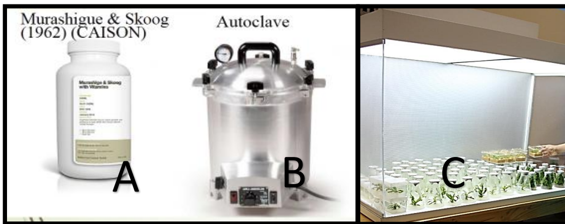
Figura 22. Material necesario para la iniciación en el cultivo in vitro de plantas: A: Murashige y Skoog 1962, marca “CAISON”. B: Autoclave. C: Cámara de flujo laminar.
