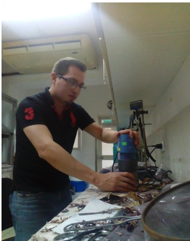
Figura 16. Molido de muestras de coronta y bráctea, estas deben ser lo más finas posibles
