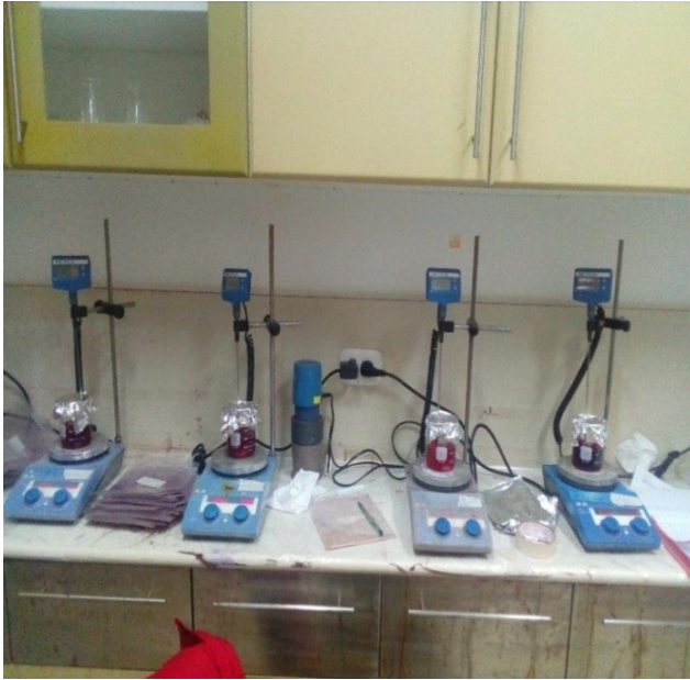
Figura 18. Agitador magnético en la cual se encuentran 0.30 g de coronta o 0.40 de bráctea + 100 ml de hidroácido.
