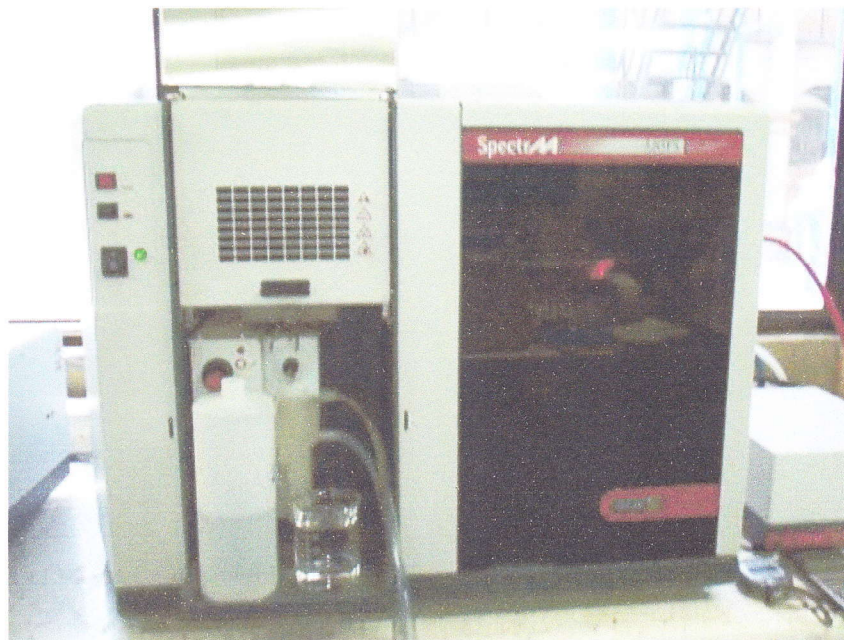
Fig. 12. Espectrofotómetro de Absorción Atómica (Modelo Spectra 220FS) ubicado en el Laboratorio de Análisis Instrumental.
