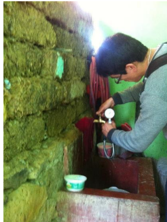
FOTO 33: Medición de presión con manómetro en las piletas domiciliarias.
