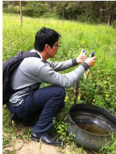
FOTO 36: Medición de presiones con manómetro en piletas domiciliarias
