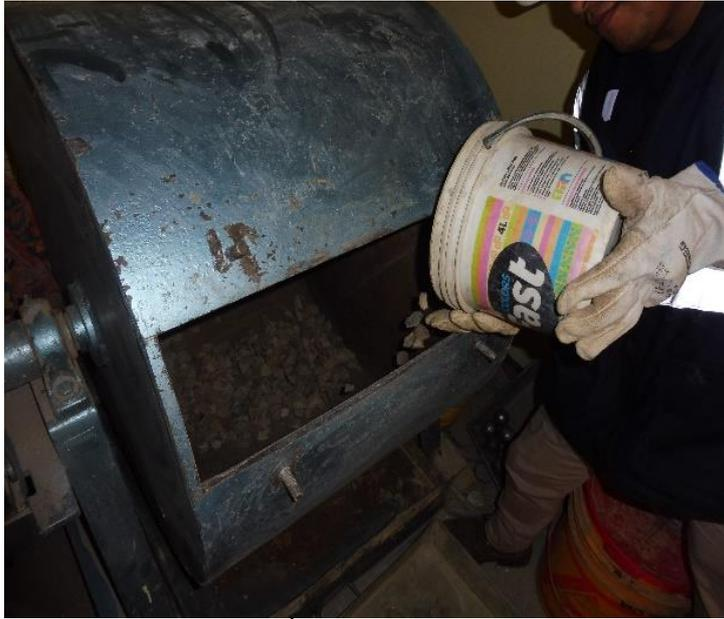
**Imagen 8.** Máquina de los Ángeles para realizar el ensayo a la abrasión.
