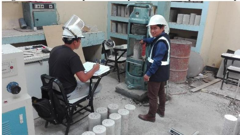
**Imagen 35.** Realizando el ensayo a compresión de todos los especimenes, tanto concreto patrones y concretos con aditivos.
