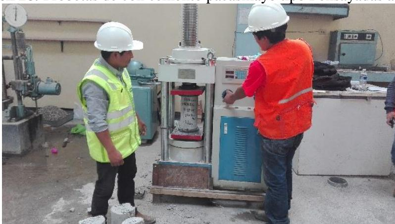
**Imagen 29.** Con el apoyo del encargado del laboratorio en el manejo correcto de la Maquina de ensayo a compresión.
