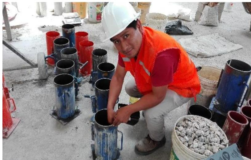
**Imagen 15.** Preparación de probetas para el concreto.
