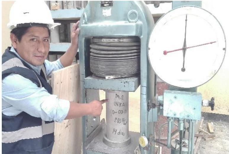
**Imagen 32.** Ensayos de las probetas con cemento Inka tipo ICo.
