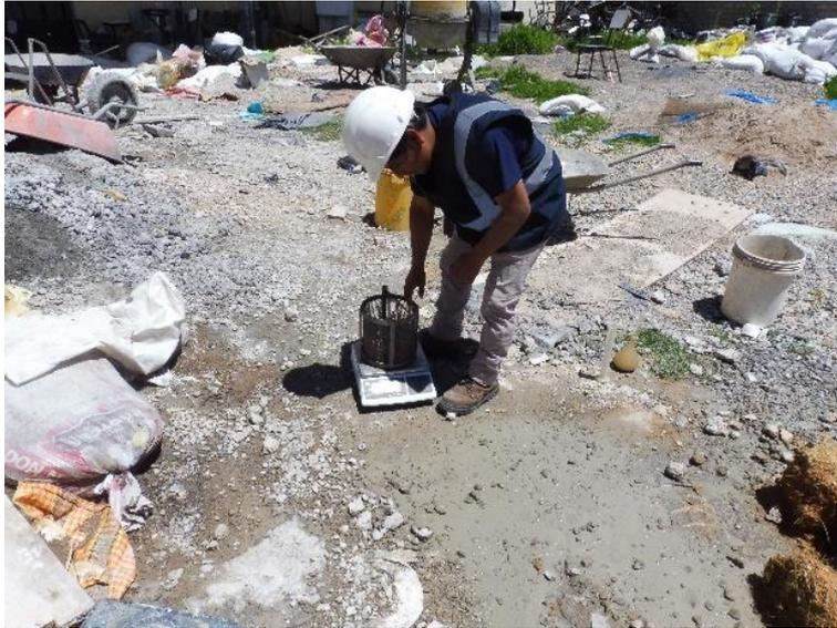
**Imagen 4.** Ensayo para la determinación del peso específico del agregado grueso.
