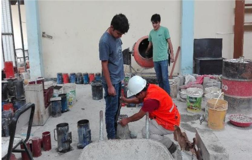
**Imagen 19.** Ensayo para la determinación del Slump.
