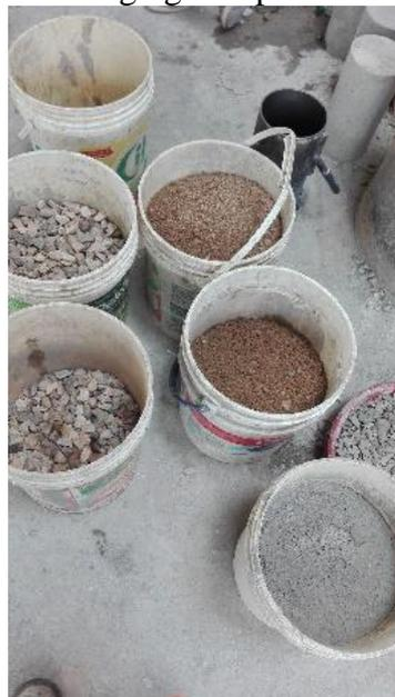
**Imagen 13.** Agregados para la mezcla de concreto  $f'c=280 \text{ kg/cm}^2$
