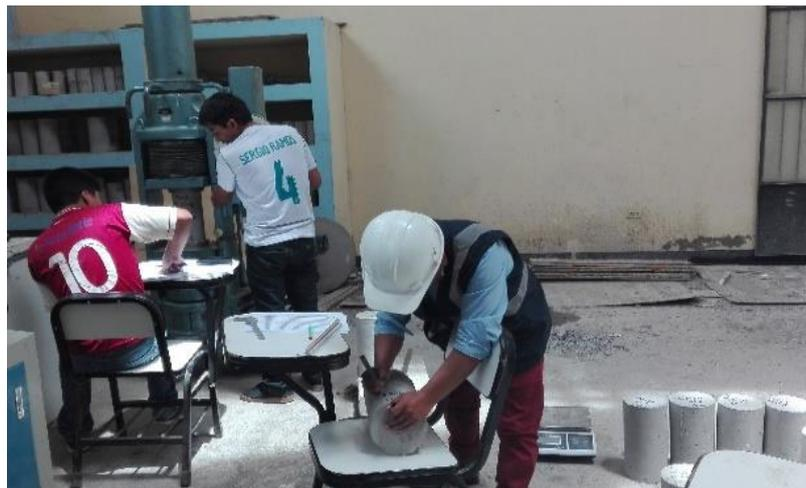
**Imagen 30.** Codificación de las probetas de concreto.
