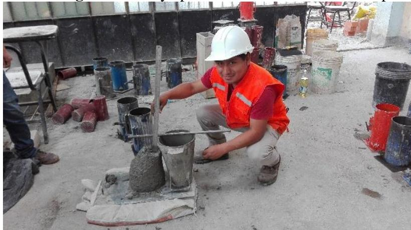
**Imagen 20.** Medición del slump, obteniendo una consistencia plastica.
