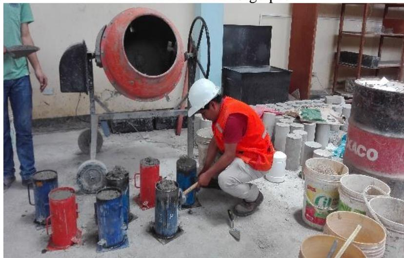
**Imagen 23.** Después de llenado se golpea con un maso de goma para obtener una distribución uniforme.
