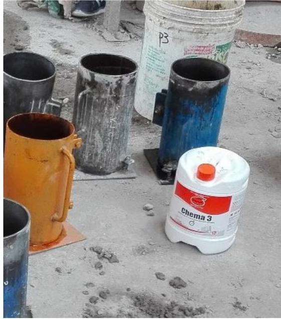
**Imagen 14.** Presencia del aditivo chema 3, utilizado para la mezcla de concreto.
