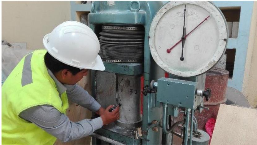
**Imagen 27.** Después del curado correspondiente realicé el ensayo a la compresion a los 7 días.
