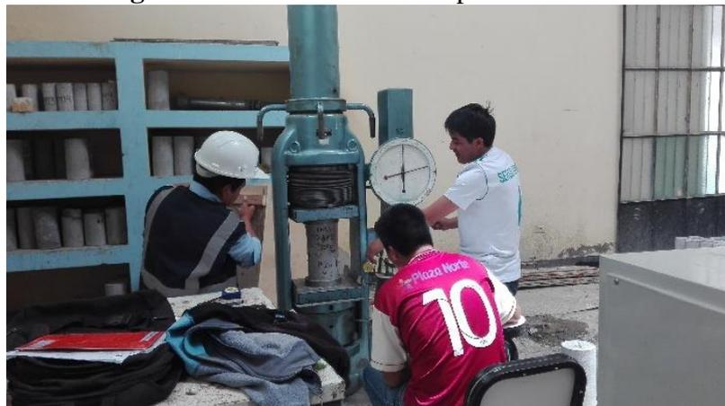
**Imagen 31.** Ensayos a la compresion a los 14 dias.
