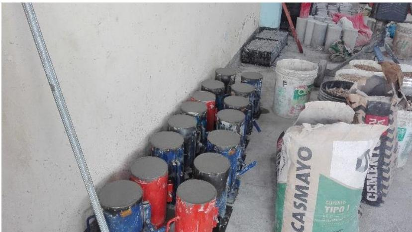
**Imagen 24.** Encofrado de probetas.
