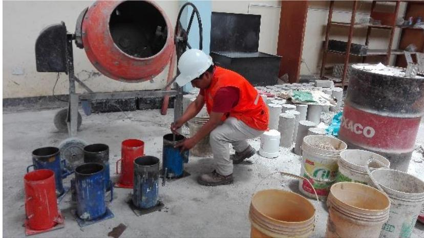
**Imagen 22.** El llenado de las probetas lo realice en tres capas, siendo compactadas cada una con 25 golpes.
