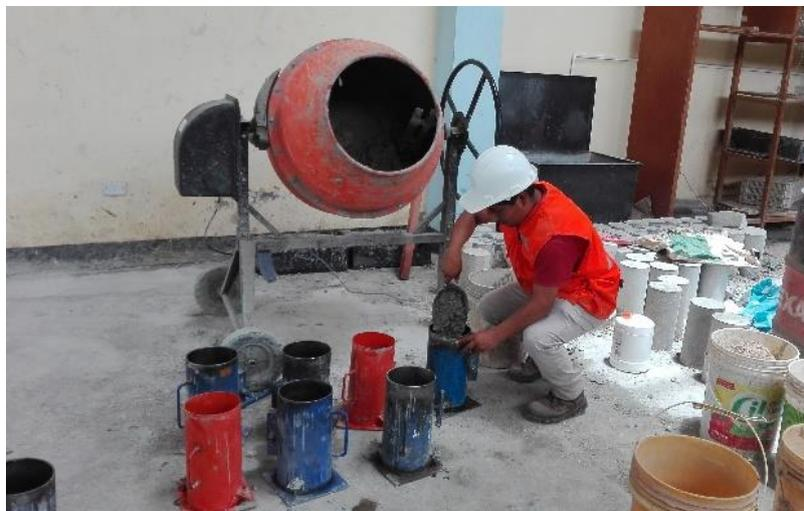
**Imagen 21.** Llenado de las probetas con concreto.
