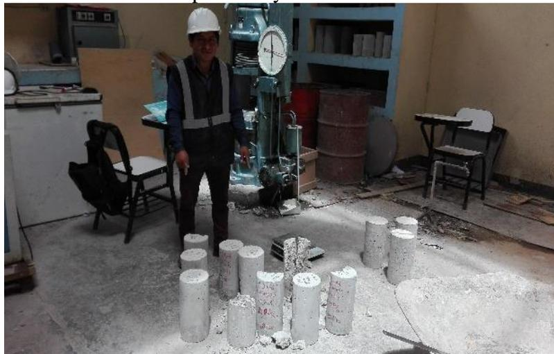
**Imagen 36.** Se muestran probetas realizadas el ensayo a la compresión a los 28 días.
