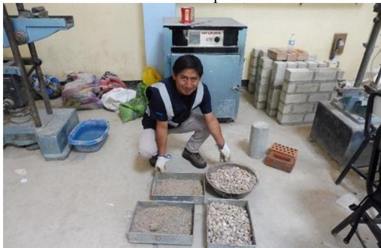
**Imagen 3.** Selección de los agregados mediante el método de cuarteo.
