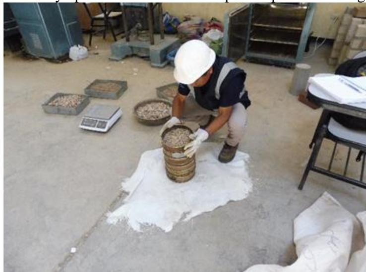
**Imagen 6.** Análisis granulométrico de los agregados.
