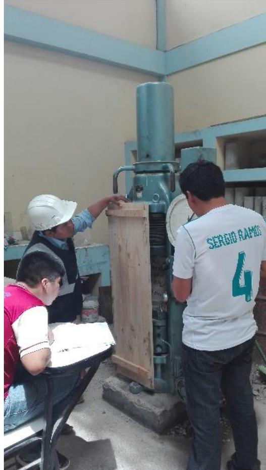
**Imagen 33.** Toma de datos de los ensayo a compresión.
