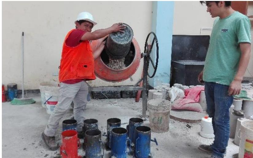
**Imagen 17.** Colocación de los agregados al trompo.
