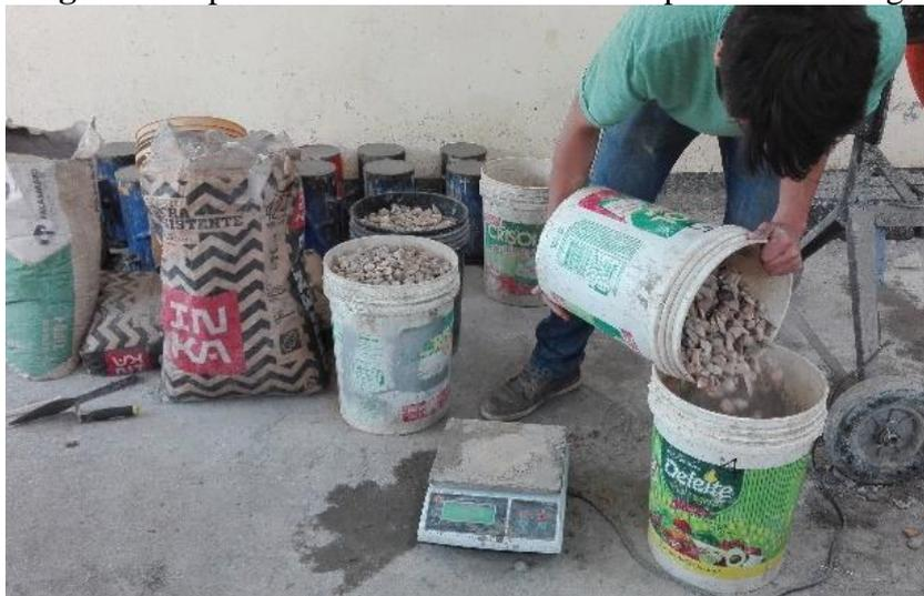
**Imagen 12.** Peso de los agregados para la mezcla de concreto.
