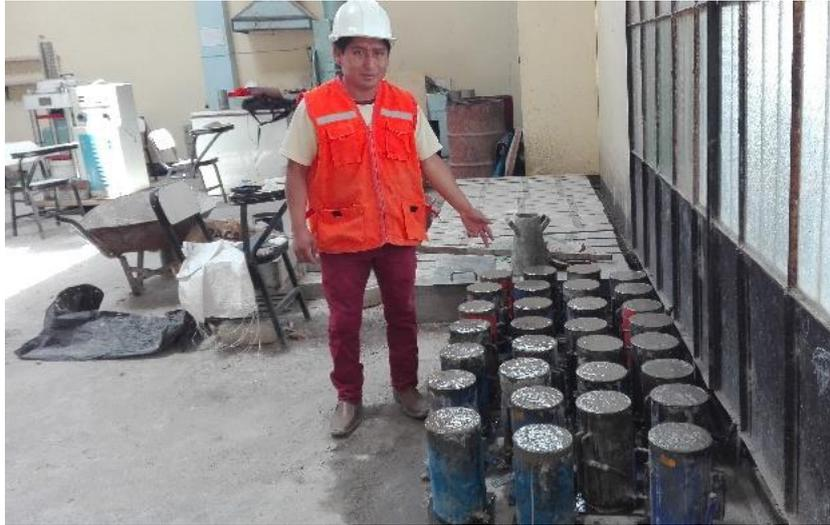
**Imagen 25.** Encofrado de probetas.
