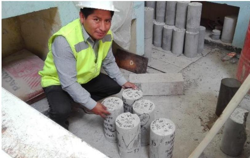
**Imagen 28.** Probetas de con cemento pacasmayo tipo I ensayadas a los 7 días.
