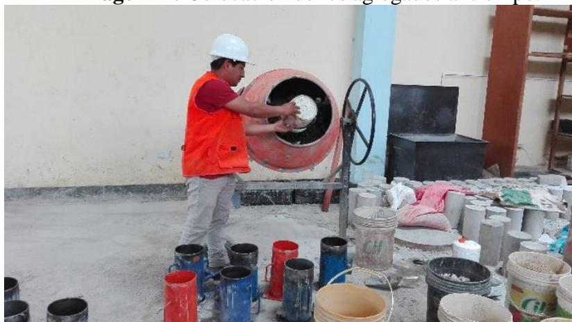
**Imagen 18.** Colocación del agua a la mezcla de concreto.
