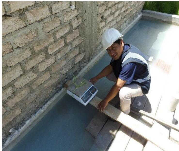
**Imagen 7.** La grava fue sumergido al agua para determinar el peso específico y la absorción.
