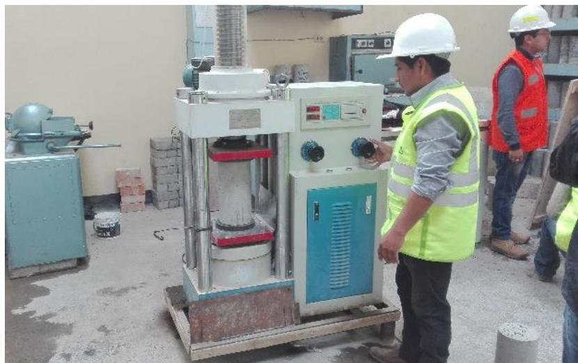
**Imagen 26.** Probetas con cemento Inka Ultrarresistente ensayadas a los 7 días, con la ayuda del encargado de Laboratorio de Materiales.
