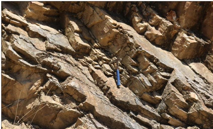
*Foto 1:* Macizo rocoso fracturado con varias familias de discontinuidades y zonas con diferente grado de alteración en areniscas.
