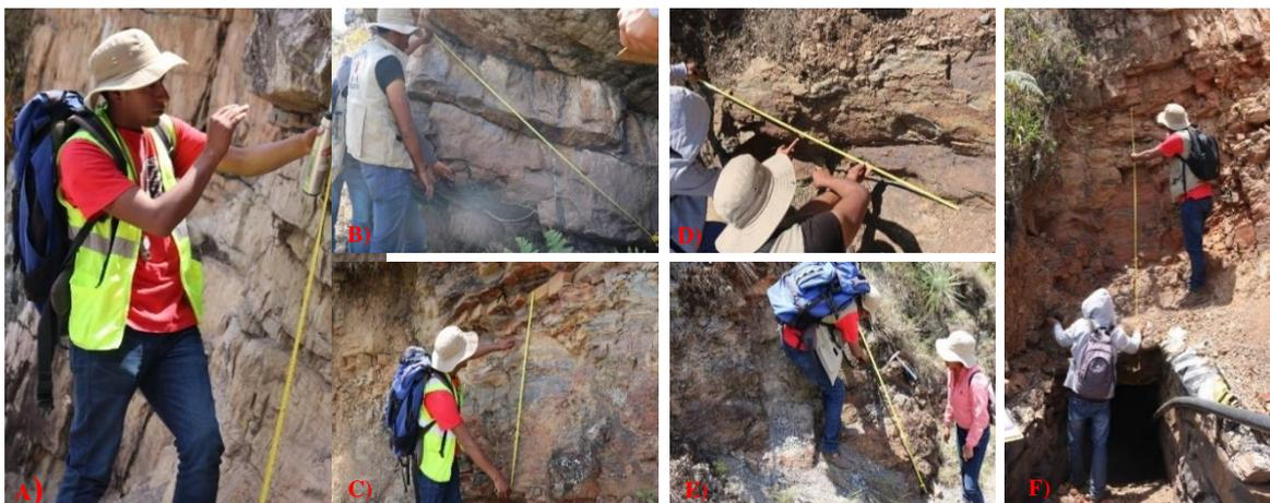
Foto 11: Toma de datos para el cálculo del RQD: A) y B) Fm Farrat; C) y D) Fm Carhuáz; E) y F) Fm Chimú.
