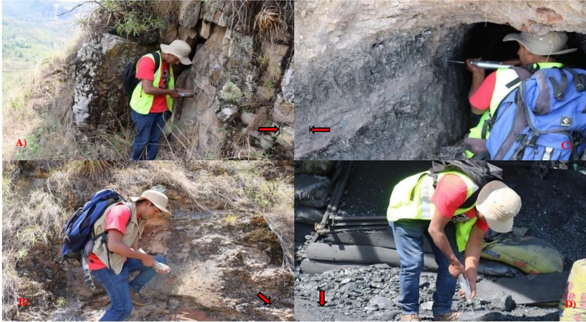
*Foto 12:* Muestras del NReb con el martillo SCHMIDT: A) y C) En sentido horizontal; B) En sentido inclinado tomadas y D): En sentido vertical tomadas en una muestra de carbón antracita.
