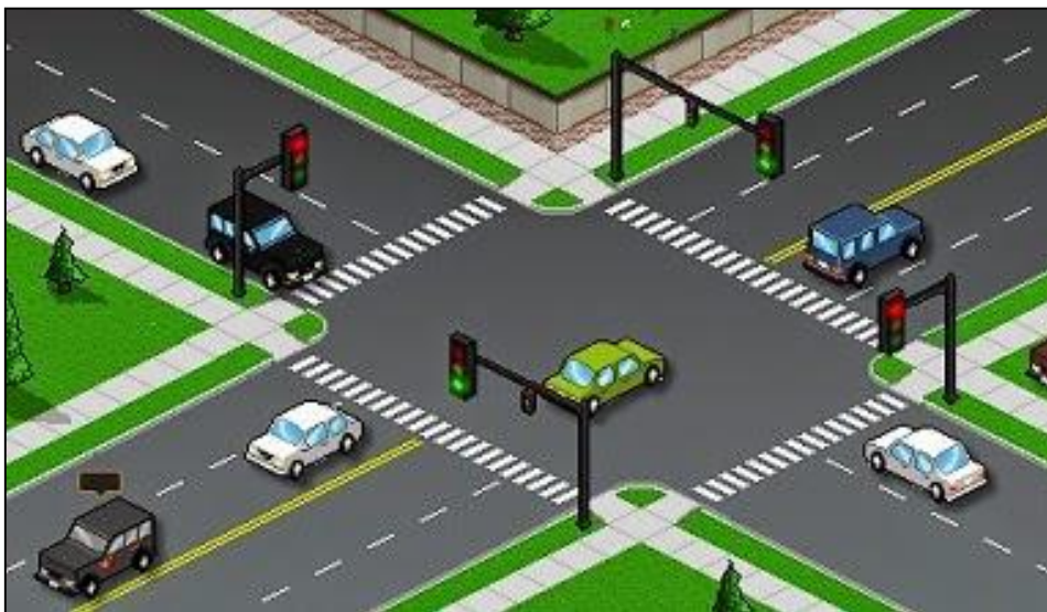
Figura 6: Intersección semaforizada de cuatro accesos.
