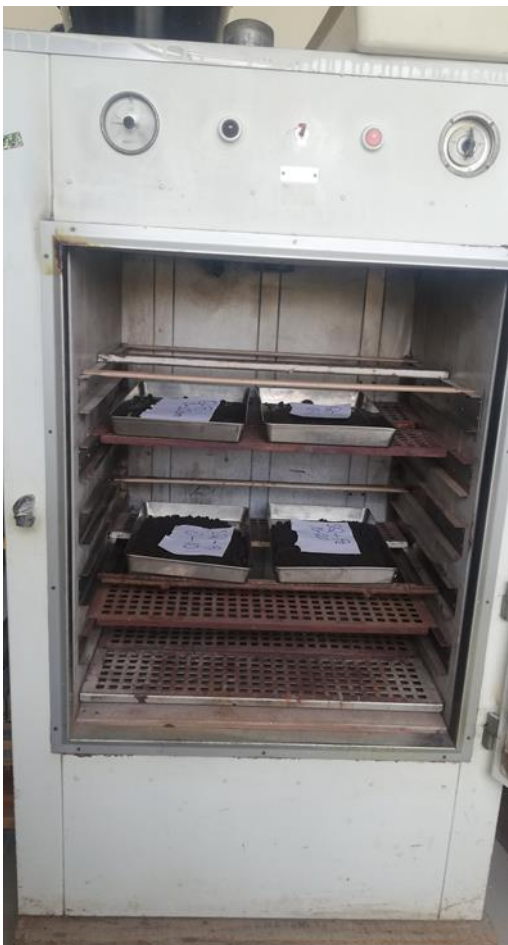
Figura 17. Colocación de las muestras en la estufa a una temperatura de 100 °C por 24 horas
