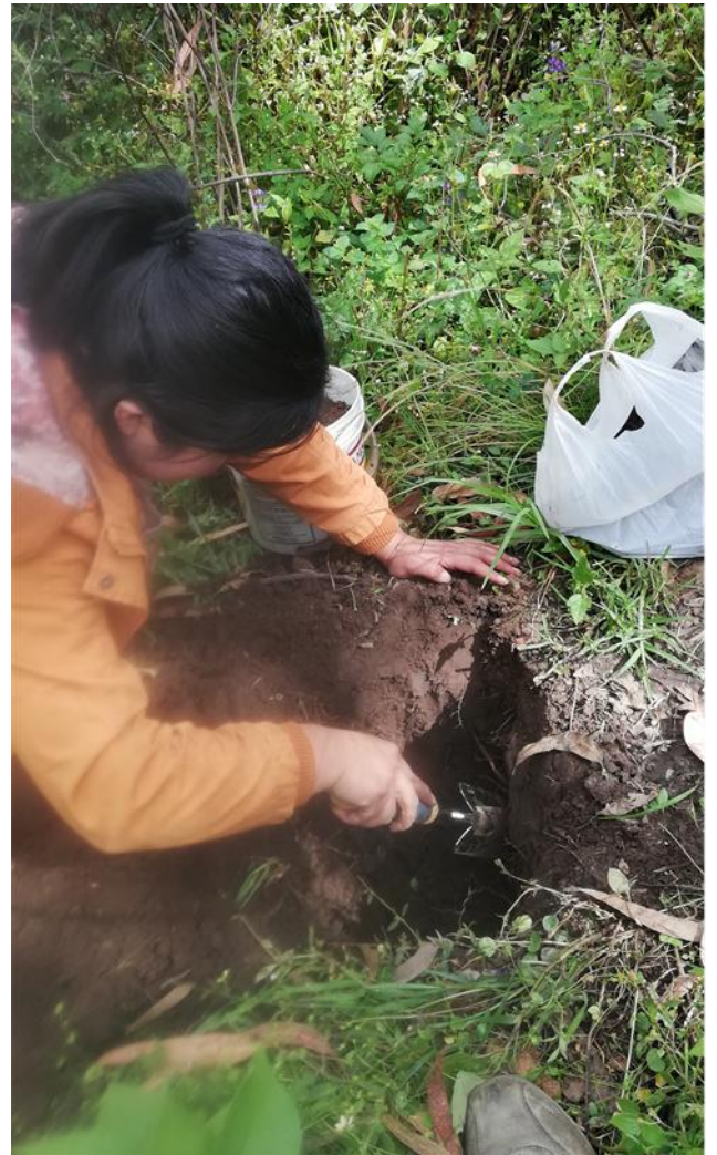
Figura 12. Medimos las profundidades en las que se van a tomar las muestras
