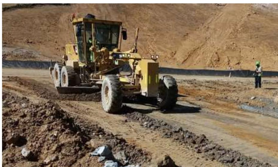
Foto 6. Motoniveladora limpiando vía de transporte en el ingreso al DME
