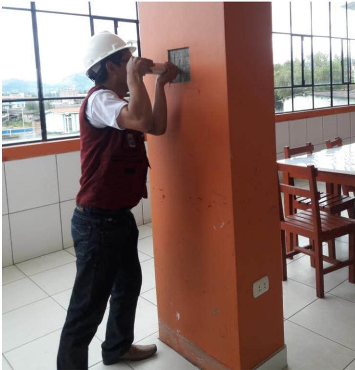
**Figura 04:** Ensayo de esclerometría
