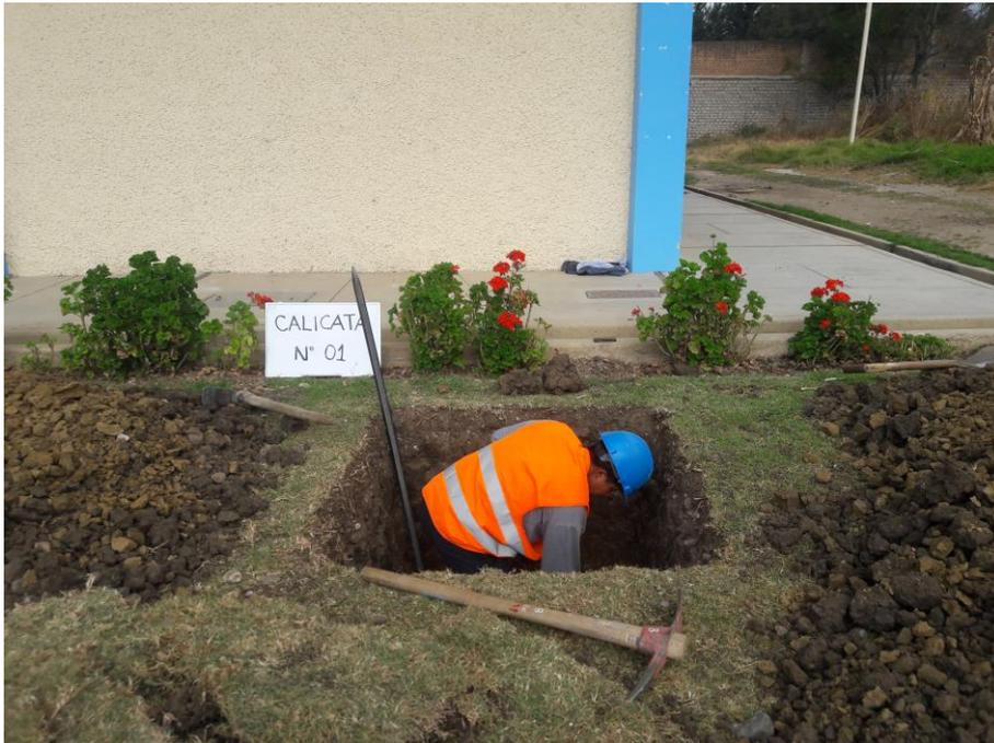
**Figura 02:** Muestras para ensayos de mecánica de suelos
