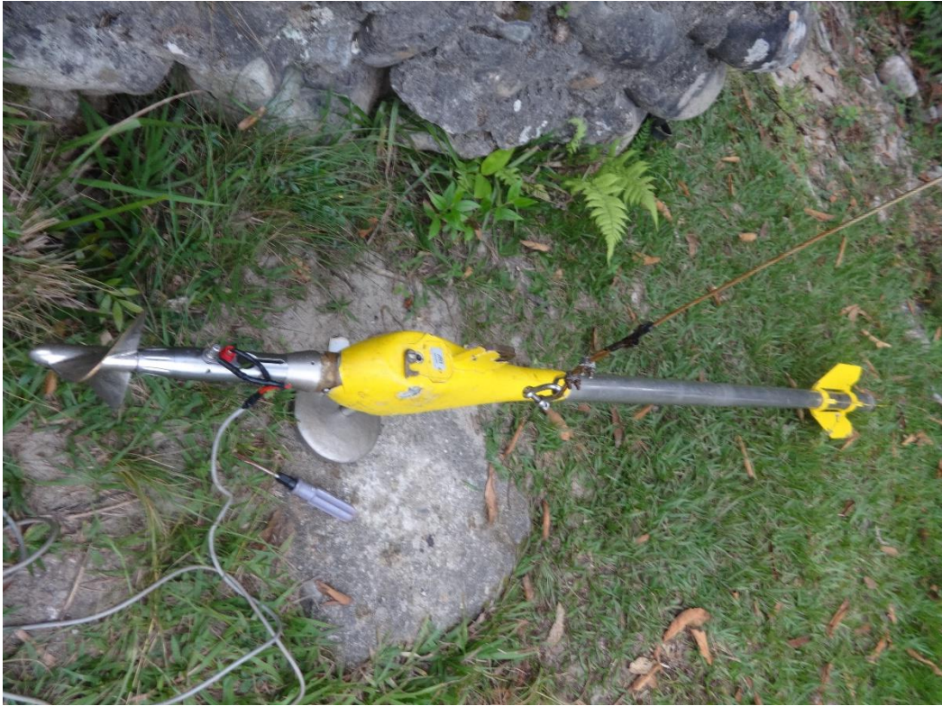
Figura 44 Correntómetro para aforo en suspensión de la estación hidrológica Tabaconas Código 220812.
