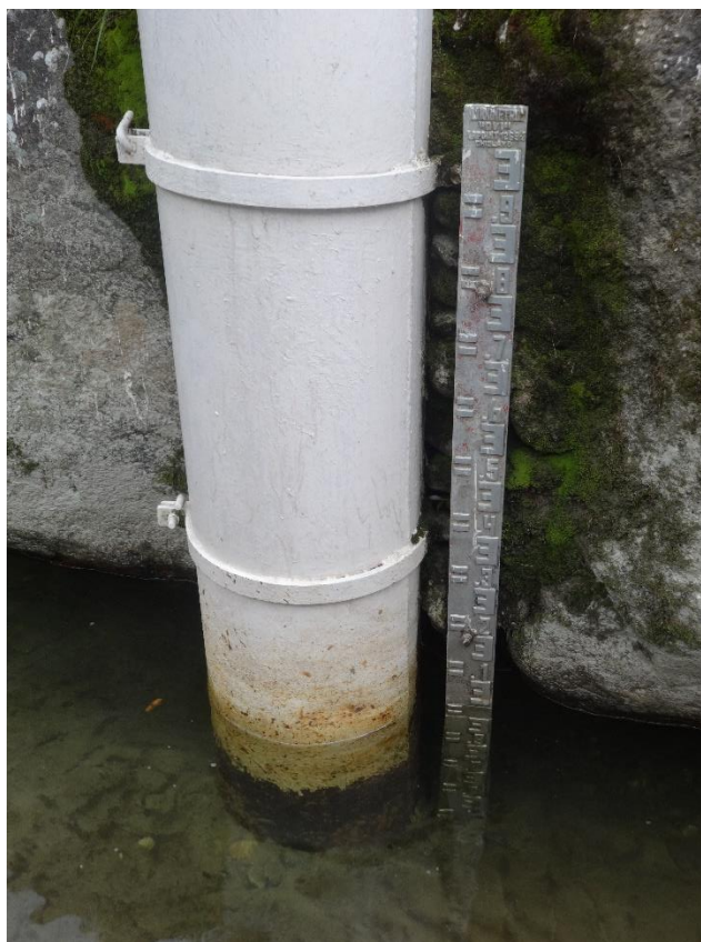
Figura 43 Regla limnimétrica para la medición de niveles de la estación hidrológica Tabaconas Código 220812.
