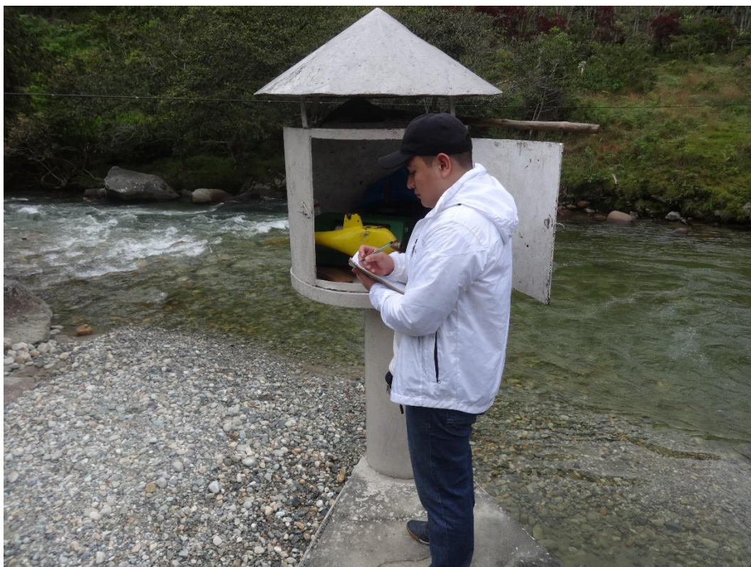
Figura 42 Estructura del Limnígrafo de la estación hidrológica Tabaconas Código 220812
