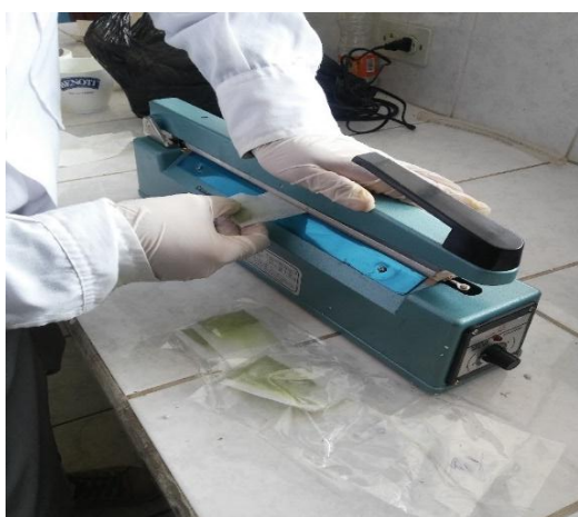
Figura 12. Sellado manual de bolsitas filtrantes.
