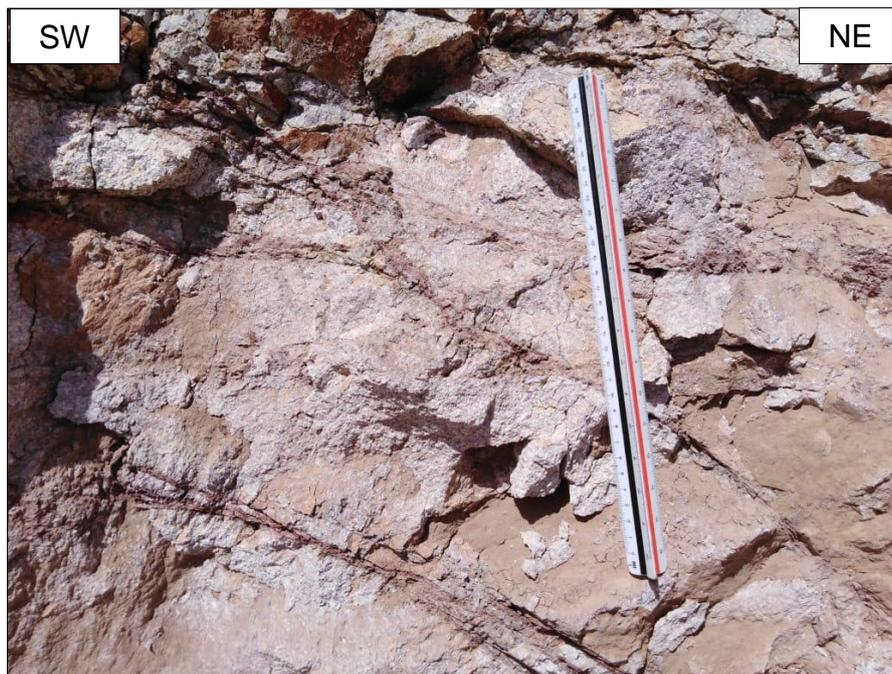
Foto 01. Dacitas altamente erosionadas por la presencia de agua.
