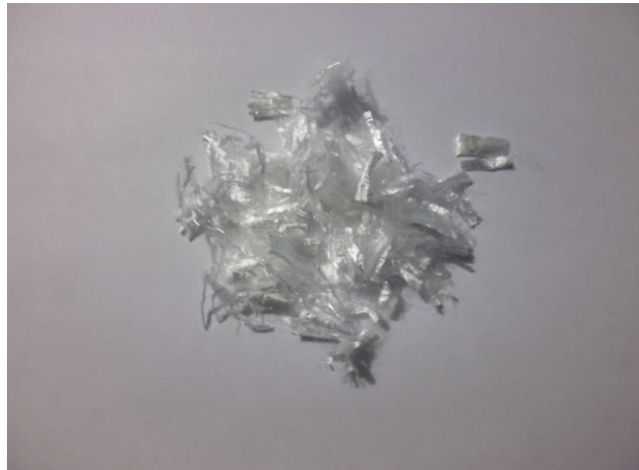
Imagen 8: Microfibra de polipropileno “Chema fibra ultrafina ”
