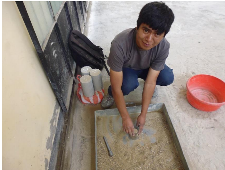
Imagen 17: determinado si el agregado fino está saturado superficialmente seco
