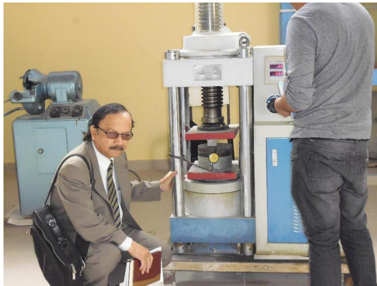
Imagen 28: Ensayo a compresión del mortero ( 5x5x5 cm)
