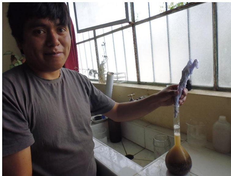
Imagen 18: Peso específico del agregado fino.
