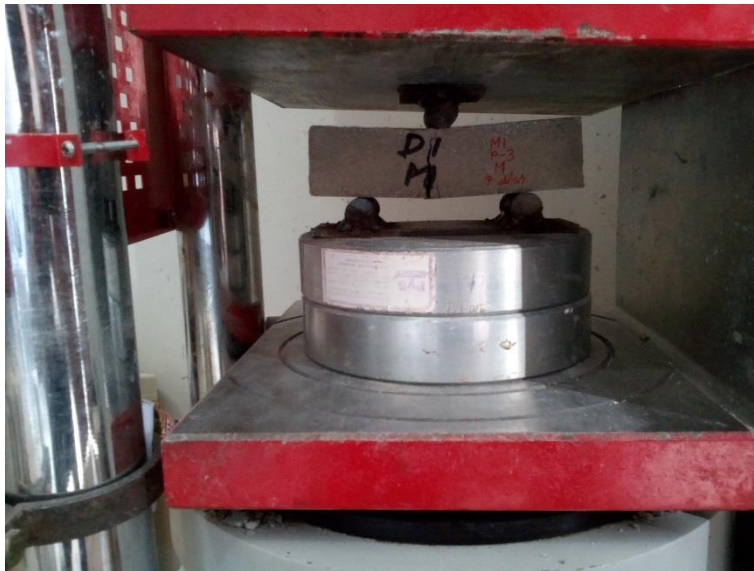
Imagen 34: Falla de la probeta a compresión.
