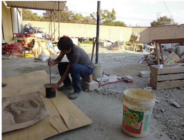
Imagen 19: Peso unitario seco compactado del agregado fino.
