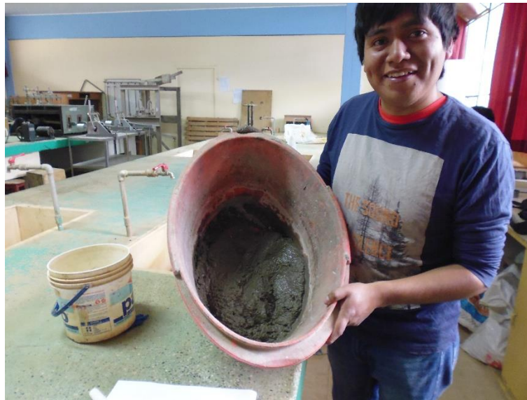
Imagen 23: Mezcla del mortero.
