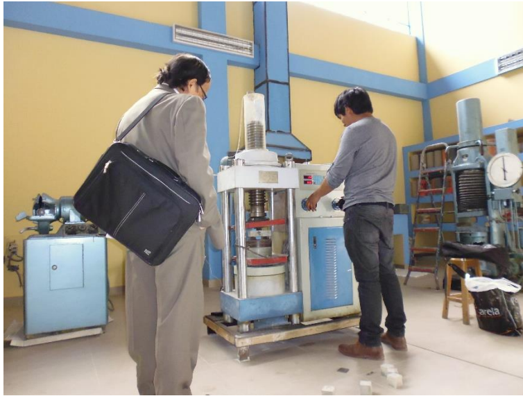
Imagen 31: Ensayo a flexión del mortero ( 4x4x16 cm)
