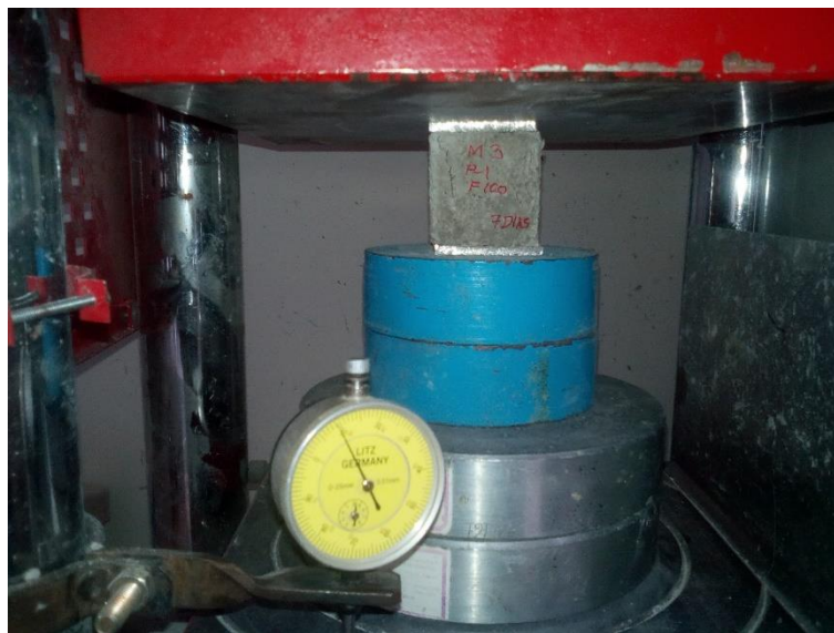
Imagen 30: Falla de la probeta ensaya a compresión.
