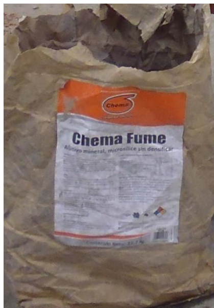
Imagen 7: Microsilice “Chema Fume”.
