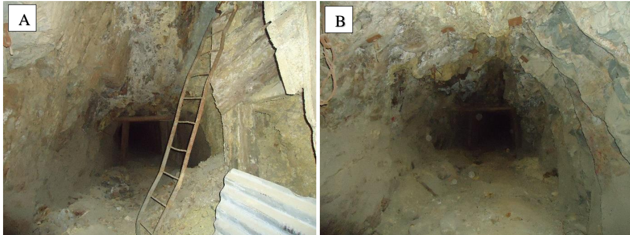
Figura 4.8 A. Roca andesita de coloración gris verdusca de calidad regular. B. Roca Traquiandesita con presencia de óxidos de Fe. Rellenando fracturas en el hastial derecho y una alteración Argílica Avanzada la cual le da una tonalidad rojiza sumada a ello la alteración ha originado una roca de muy mala calidad.
