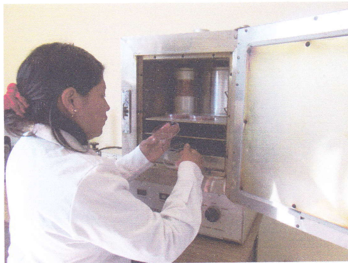
Fig. 11. Inclusión en Parafina: Método de Inclusión en Parafina. Impregnación 3 baños en parafina a 60°.
