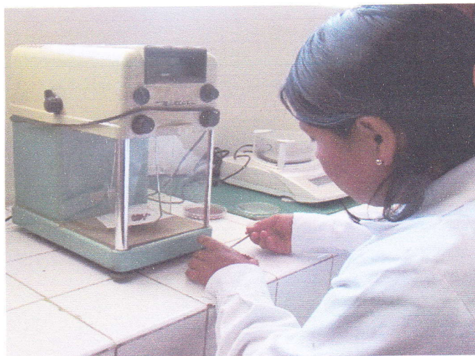
Fig. 8. Pesar 5 g de Achiote ( Bixa Orellana ) molido, fueron disueltos en 100 ml de alcohol absoluto (etanol). Laboratorio de Química y Dinámicas de la Universidad Nacional de Cajamarca.
