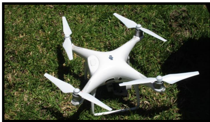
Figura 13: Foto de Dron Phantom 4 Pro con el que se realizó el levantamiento topográfico
