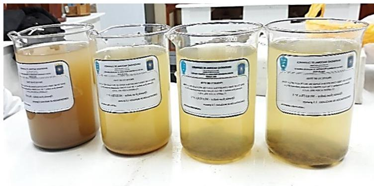
**Figura 13.** Proceso de coagulación-floculación
