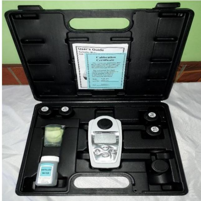
**Figura 27 .** Turbidímetro utilizado para medir la turbiedad de las muestras tratadas con los cactus tuna y San Pedro.
