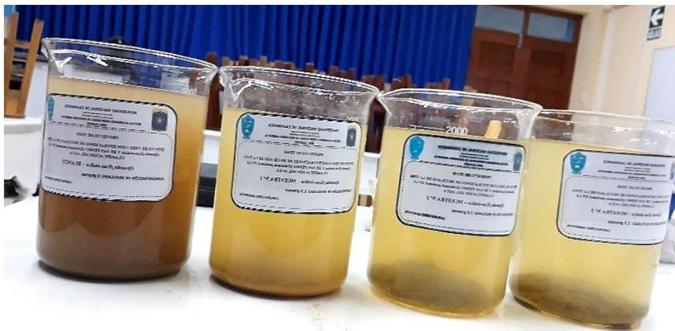
**Figura 26.** Proceso de clarificación usando las diferentes soluciones de mucílago de tuna.
