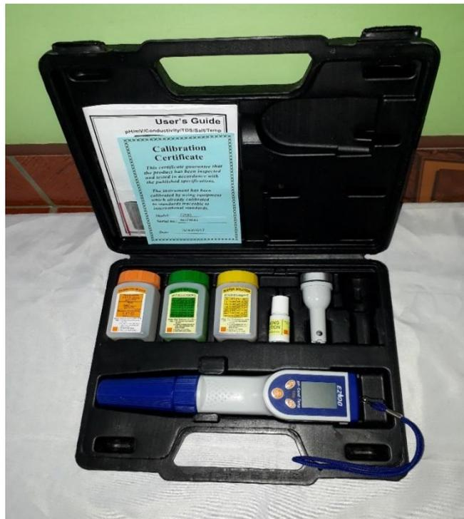
**Figura 28.** Equipo utilizado para determinar sólidos disueltos totales (SDT), conductividad eléctrica, temperatura, pH de cada muestra tratada
