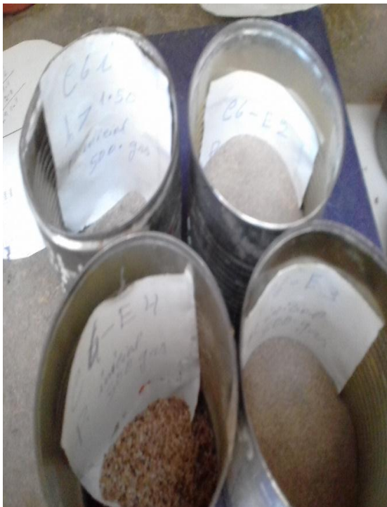
Figura 146. Ensayo de contenido de humedad.
