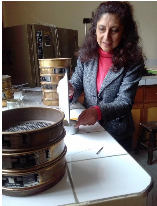
Figura 147. Ensayo de granulometría
