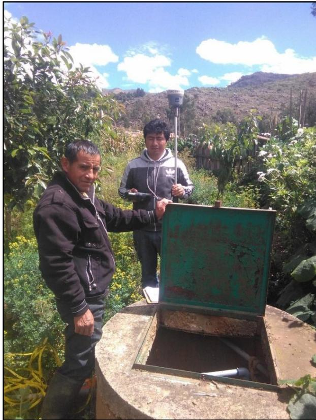
Figura 20: Ecosonda para la prueba de bombeo pozo N° 02 de la Universidad Nacional de Cajamarca
