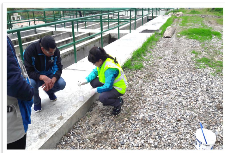
Fotografía N° 8 Aplicación de reactivos para la conservación de las muestras de aguas residuales
