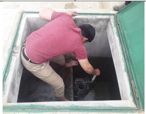
Medición de temperatura del agua filtrada
