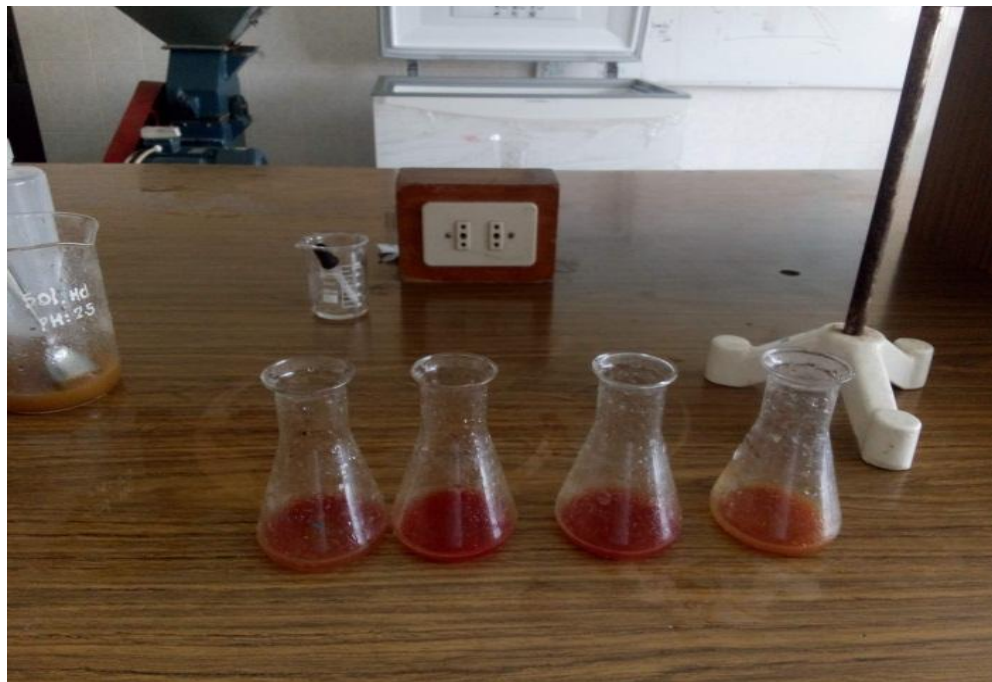
Ilustración 3. Determinación de acidez titulable
