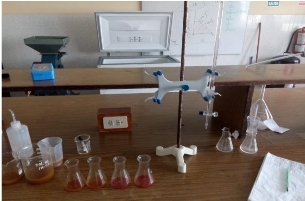
Ilustración 3. Determinación de acidez titulable
