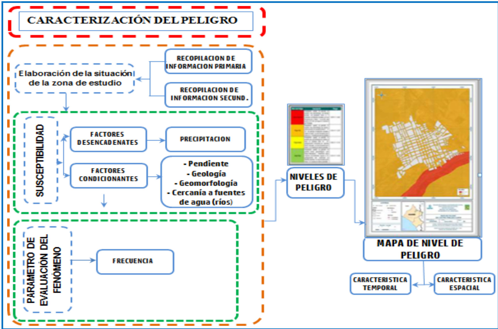
Figura 6: Metodología para determinar el nivel de peligrosidad de inundación (CENEPRED, 2014).
