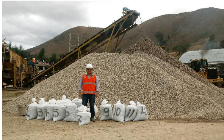
FIGURA N° 16: Tamizado de agregado grueso.
