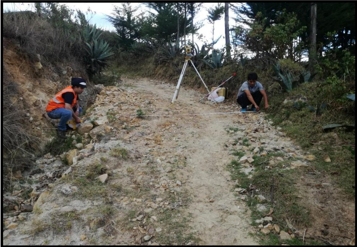
*Figura 6.3: Medición del ancho de calzada*
