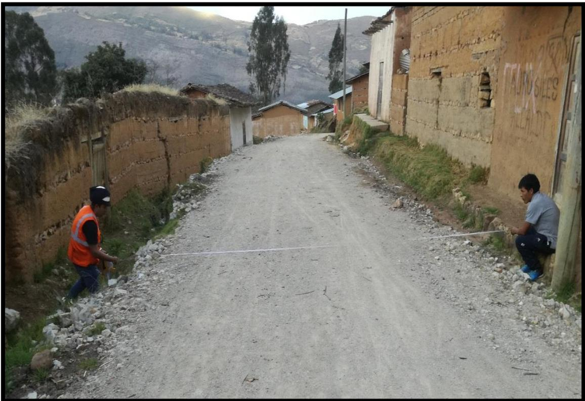
*Figura 6.4: Medición del ancho de calzada y cunetas*
