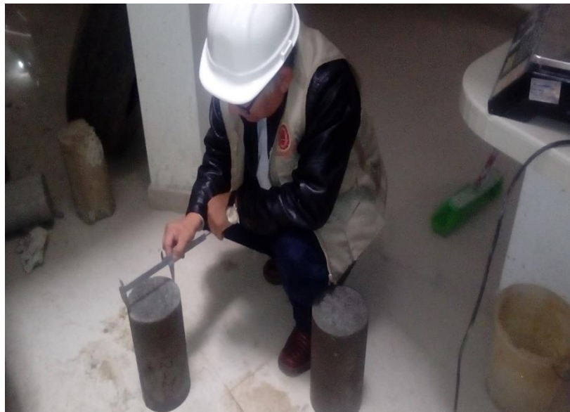
Foto N° 14: Medición de la dimensiones de las probetas fabricadas con aditivo sika viscoconcrete – 3330 y registro de su peso respectivo.
