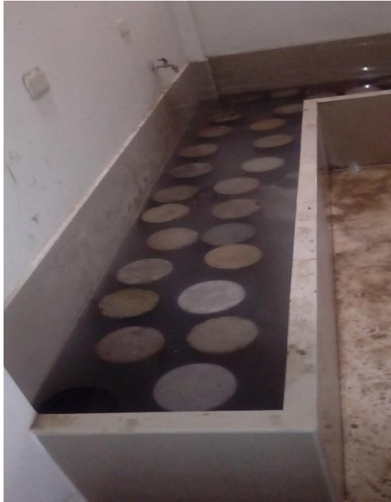
Foto N° 11: Poza del curado de las probetas de concreto.
