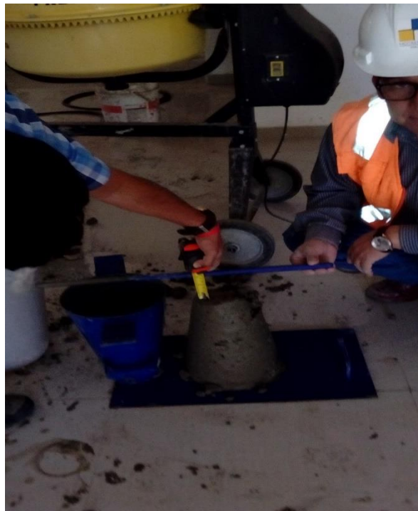
Foto N° 6: Medición del Slump, para determinar la consistencia de la mezcla de concreto F'c = 350 \text{ Kg/cm}^2 .
