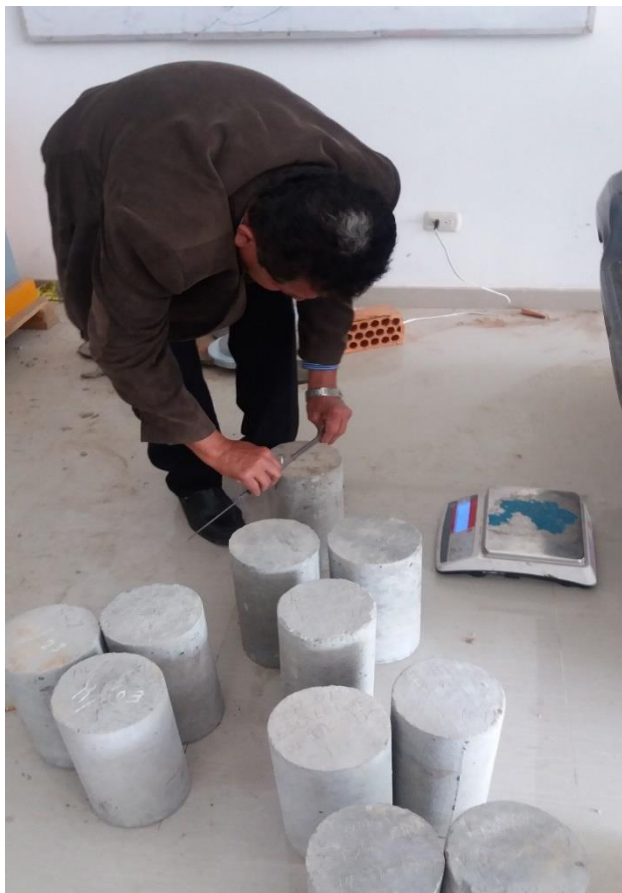
Foto N° 12: Medición de las medidas de las dimensiones de las diferentes probetas de concreto y peso de cada de ellas.
