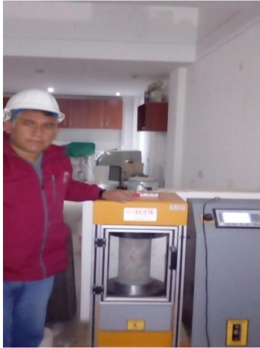
Foto N° 29: Ensayo de resistencia a la compresión de probetas en la máquina de compresión axial.
