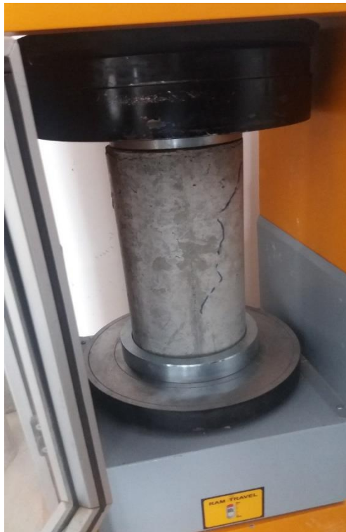
Foto N° 24: Ensayo de Resistencia a la Compresión de probetas en la máquina de Compresión Axial.
