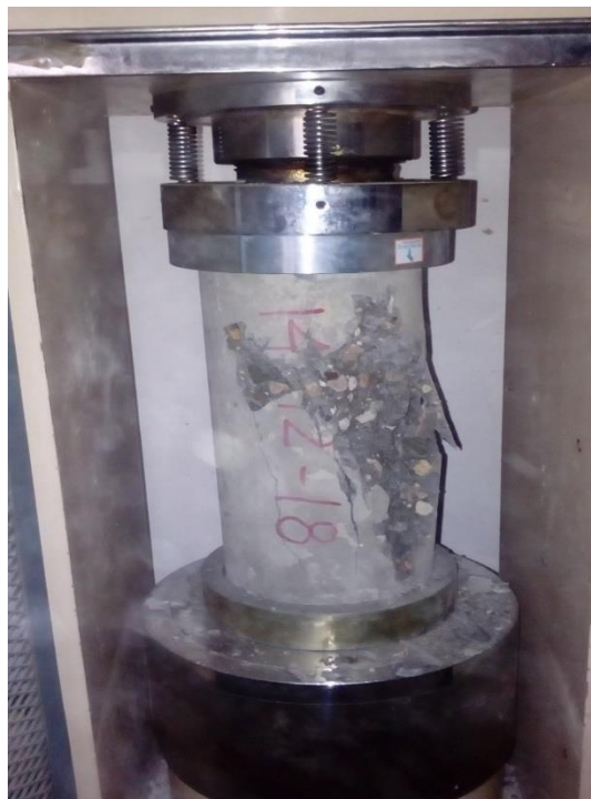
Foto N° 22: Ensayo de resistencia a la compresión de probetas con aditivo sika viscoconcrete – 3330, con máquina de compresión axial.
