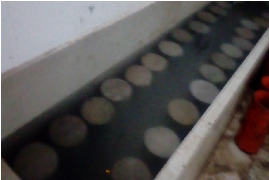
Figura N°11.- Curado de especímenes de concreto.
