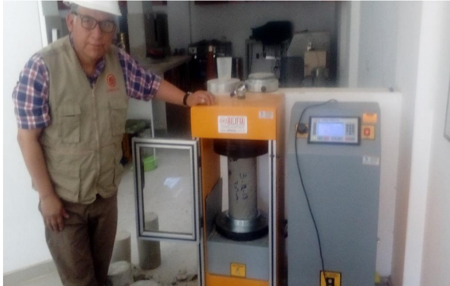
Foto N° 15: Realización del ensayo de resistencia a la compresión de probetas con aditivo sika visconcrete - 3330.
