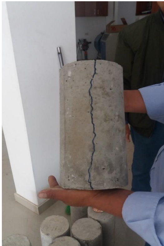
Foto N° 30: Tipo de falla en la rotura de probetas con aditivo sika viscocrete – 3330, con máquina de compresión axial.
