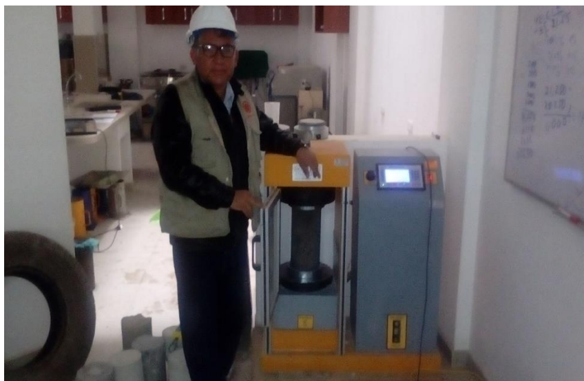
Foto N° 28: Ensayo de resistencia a la compresión de probetas con aditivo sika viscocrete – 3330, con máquina de compresión axial.
