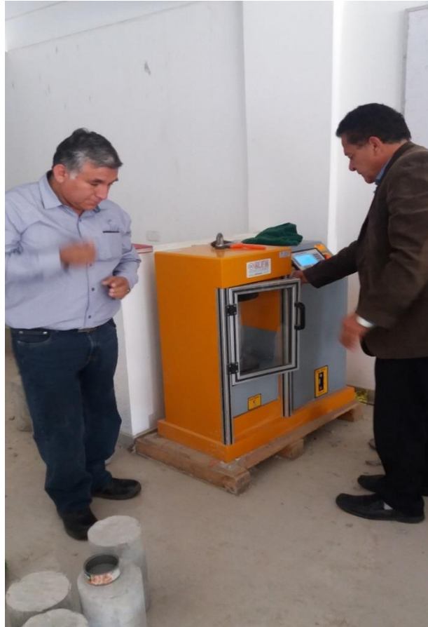
Foto N° 13: Realización del ensayo de resistencia a la compresión en la máquina de compresión axial.
