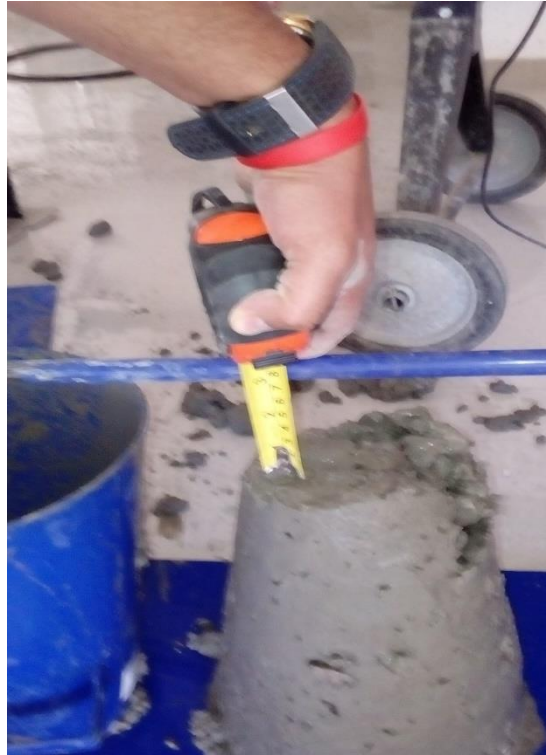
Foto N° 7: Medición del Slump, donde se nota el Slump de 3.5", de la mezcla de concreto f'c = 350 \text{ Kg/cm}^2 .
