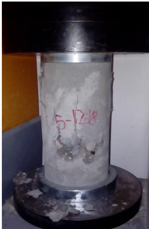
Foto N° 18: Ensayo de resistencia a la compresión de probetas con aditivo sika viscoconcrete – 3330, con máquina de compresión axial.
