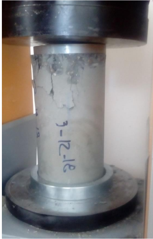
Foto N° 17: Ensayo de resistencia a la compresión de probetas con aditivo sika viscoconcrete – 3330, con la máquina de compresión axial.
