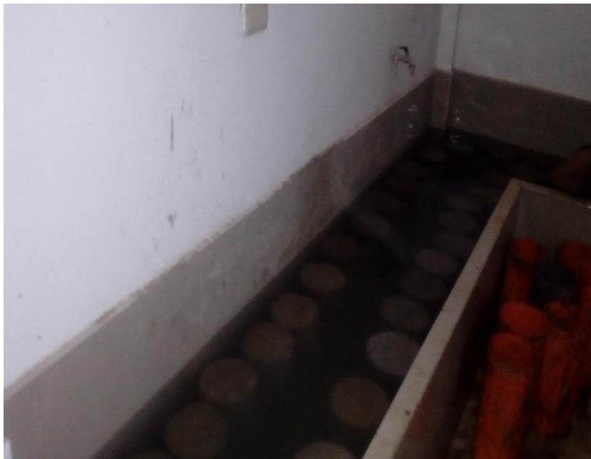
Foto N° 26: Poza de curado de especímenes en el Laboratorio de Ensayo de Materiales.
