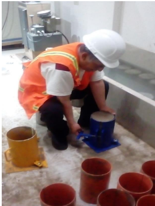
Foto N°20: Desencofrado e ingreso de especímenes a la poza de curado del laboratorio de ensayo de materiales.
