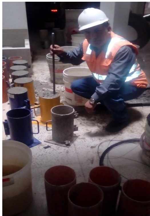
Foto N° 10: Trabajos de fabricación de las probetas de concreto con aditivo sika visocrete – 3330.
