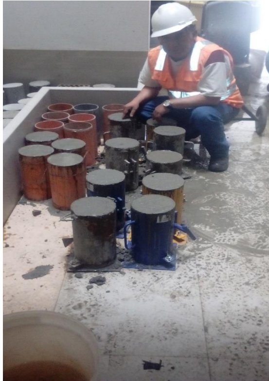
Foto N° 19: Fabricación de las probetas de concreto con aditivo sika visocrete – 3330 a diferentes porcentajes.
