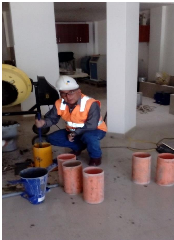
Foto N° 8: Trabajos de fabricación de las probetas de concreto sin aditivo.
