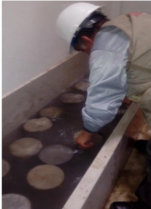
Foto N° 23: Especímenes a la poza de curado del laboratorio de ensayo de materiales.
