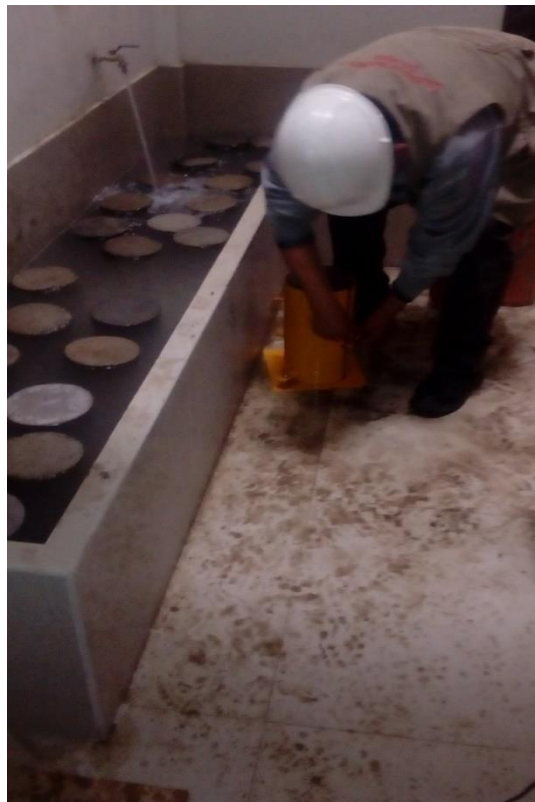
Foto N° 16: Desencofrado y colocación de más especímenes a la poza de curado del Laboratorio de Ensayo de Materiales.
