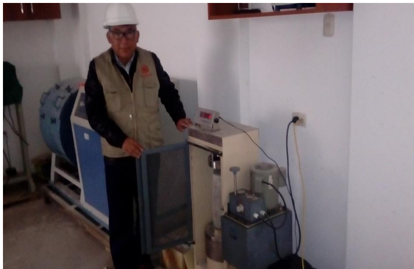
Foto N° 27: Ensayo de resistencia a la compresión de probetas con aditivo sika viscocrete – 3330, con máquina de compresión axial.
