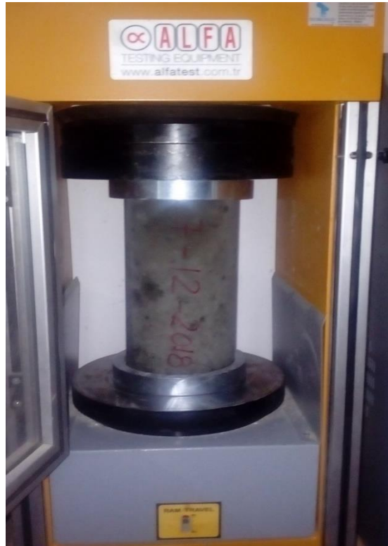
Foto N° 21: Ensayo de resistencia a la compresión de probetas con aditivo sika viscoconcrete – 3330, con máquina de compresión axial.
