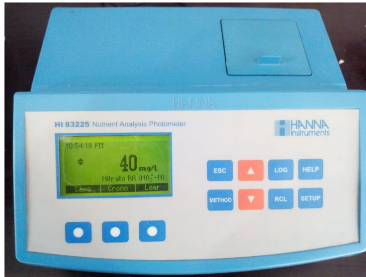
Figura 21: Fotómetro marca HANNA modelo HI 83225, empleado para la caracterización de la muestra del efluente
