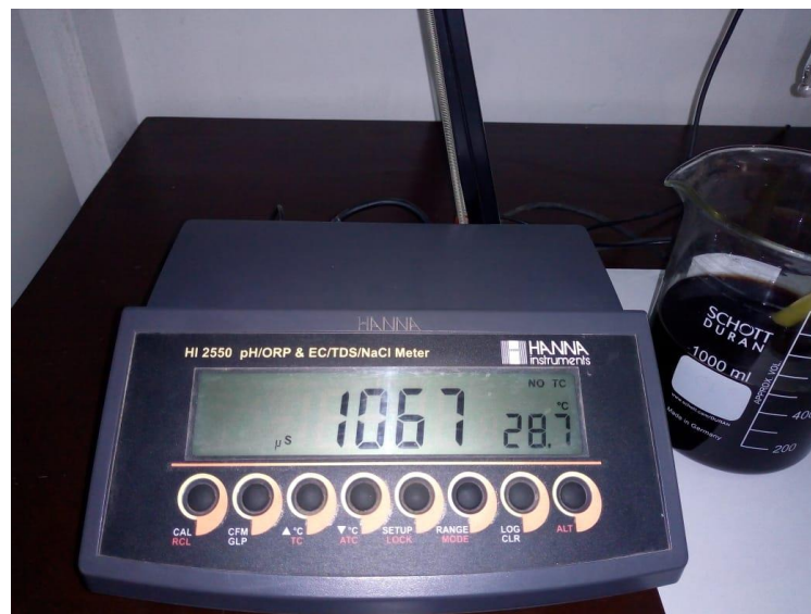
Figura 22: Caracterización de la muestra Equipo para la medición del pH, multiparámetro marca HANNA, modelo HI 2550.
