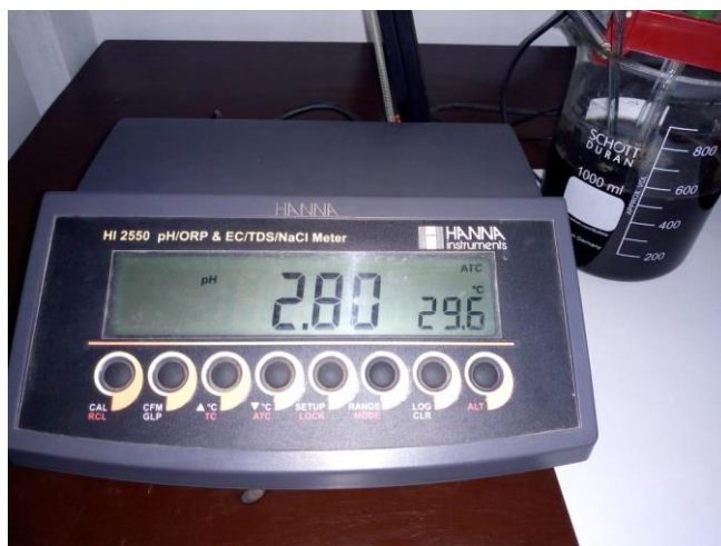
Figura 5: Equipo para la medición del pH, multiparámetro marca HANNA, modelo HI 2550.
