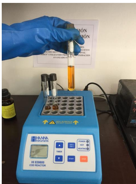
Figura 8: Determinación de la demanda química de oxígeno. Tubo conteniendo la muestra, la solución digestora y la solución catalizadora, en el termoreactor HANNA modelo 839800.
