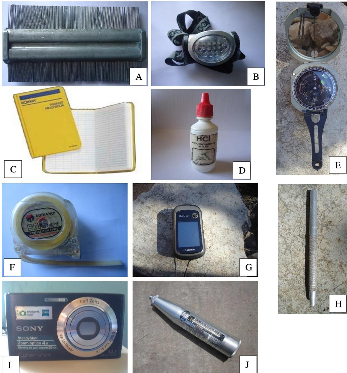
Figura 3.6. Equipos y materiales utilizados para la realización de la investigación. A. Peine de Barton, B. Lintera, C. Libreta de campo, D. Ácido clorhídrico, E. Brújula, F. Flexómetro, G. GPS, H. Rayador, I. Cámara fotográfica y J. Martillo Schmidt.
