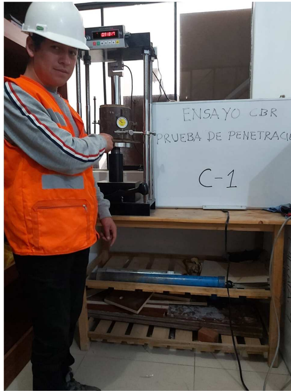
Figura 90. Realización de prueba de penetración calicata N°1
