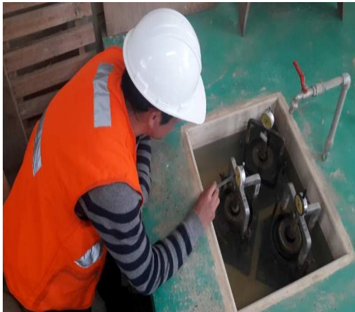
Figura 86. Lecturas del deformímetro debido al hinchamiento
