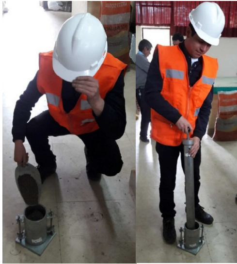
Figura 75. Llenado del molde por capas y compactación de la misma con su respectivo número de golpes
