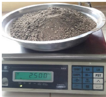
Figura 72. Peso de cada una de las muestras para el ensayo de compactación
