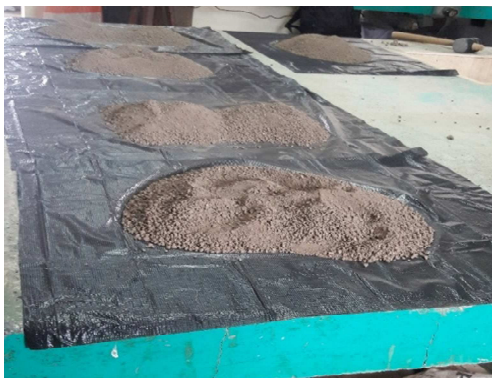
Figura 73. Muestra para realización del ensayo de compactación
