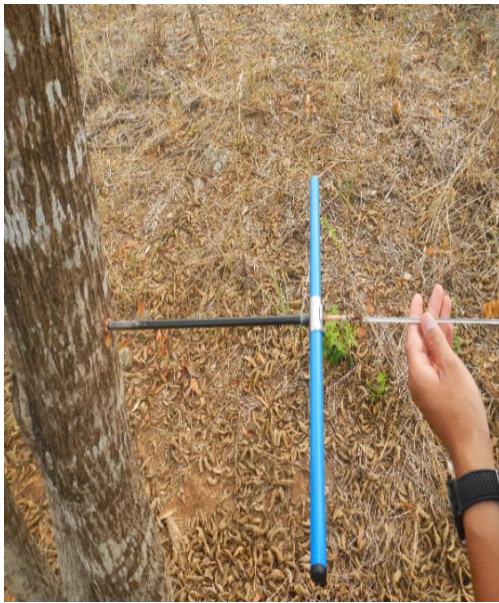
Figura 3. Extracción de muestras de madera
