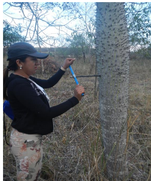
Figura 4. Uso del barreno de Pressler
