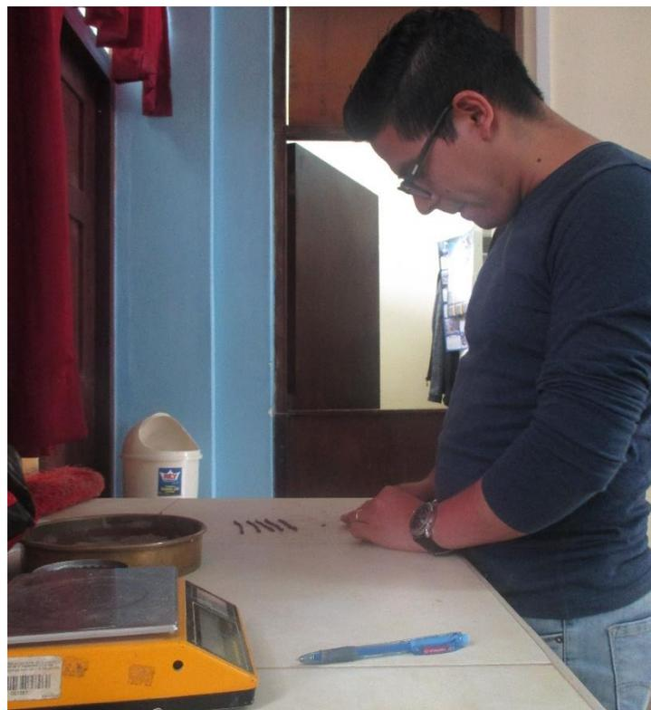
**Fotografía N° 16.-** Ensayo de Limites de Atterberg – Limite Plástico
