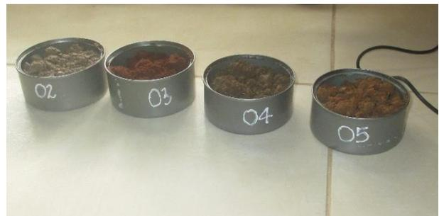
**Fotografía N° 12.-** Ensayo de Contenido de Humedad
