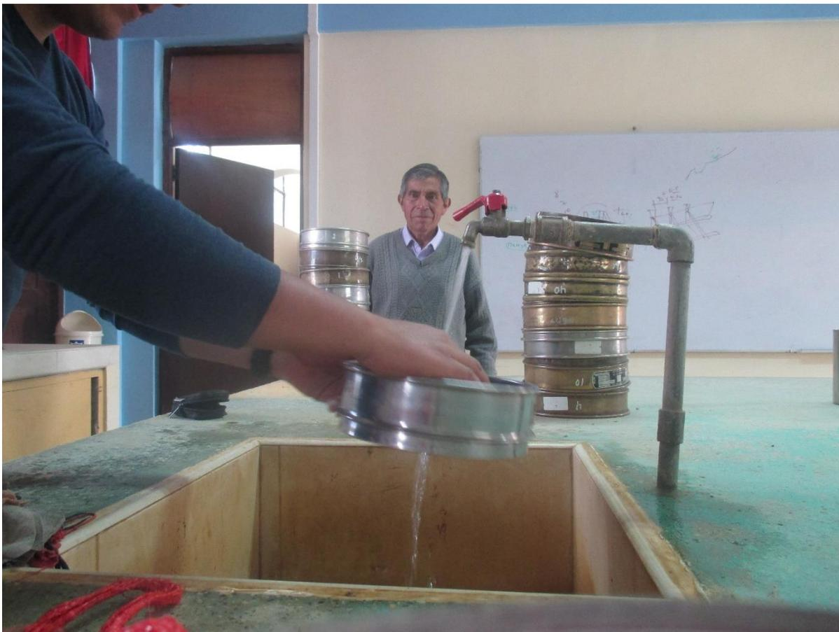
**Fotografía N° 14.-** Ensayo de Granulometría por Lavado
