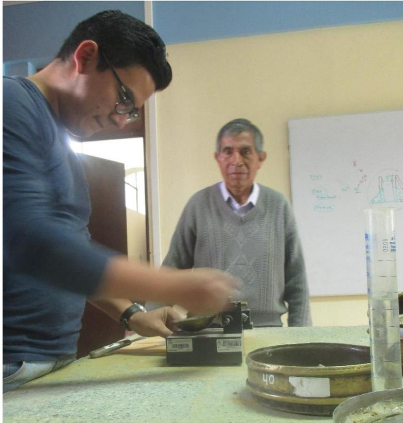
**Fotografía N° 15.-** Ensayo de Limites de Atterberg – Limite Liquido
