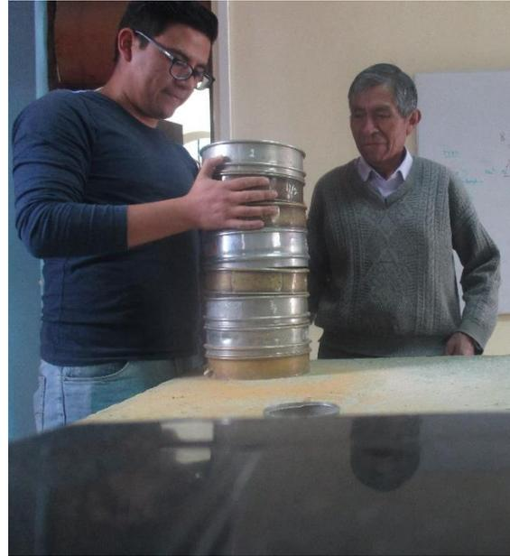
**Fotografía N° 13.-** Ensayo de Granulometría en Seco
