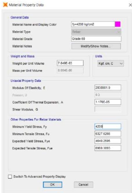
Figura N° 24: Propiedades del acero para un f_y=4200 \text{ Kg/cm}^2
