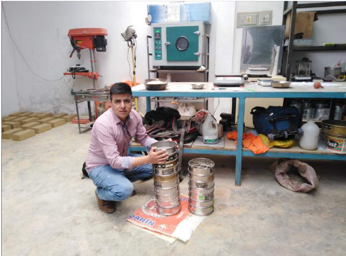
Figura N° 118: Ensayo de granulometría en el laboratorio
