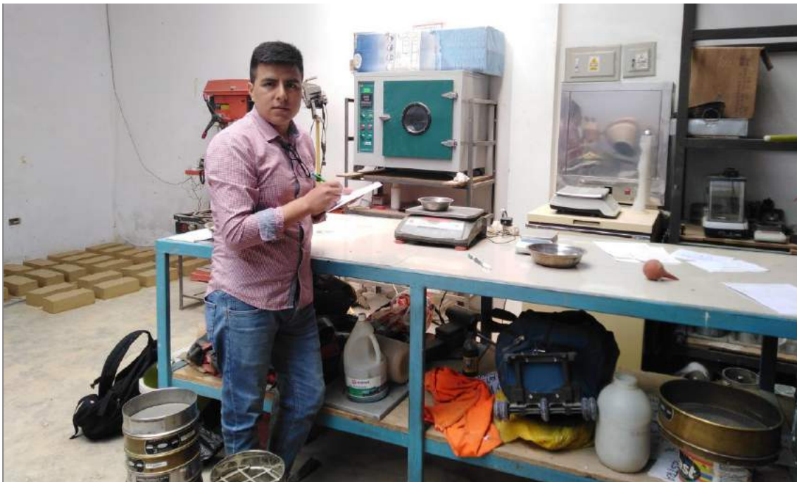
Figura N° 120: Anotación de los pesos de la muestra retenida en cada tamiz
