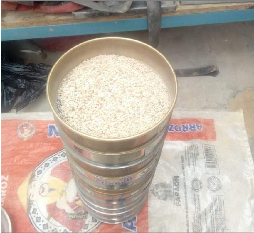
Figura N° 117: Preparación para iniciar con el ensayo de granulometría.
