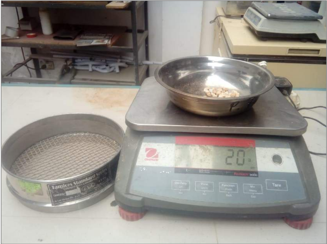
Figura N° 119: Peso de la muestra retenida en cada tamiz
