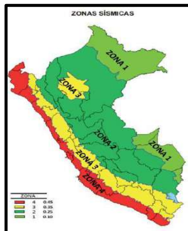
Figura 2: Zonas sísmicas del Perú.
