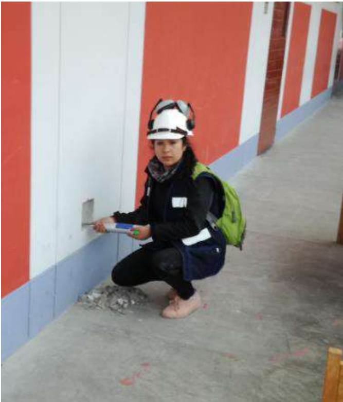
Fotografía 21 y 22: Ensayo de esclerometría en columnas y vigas el módulo 03.
