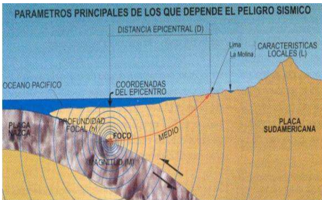
Figura 6: Parámetros principales de los que depende el peligro sísmico.
