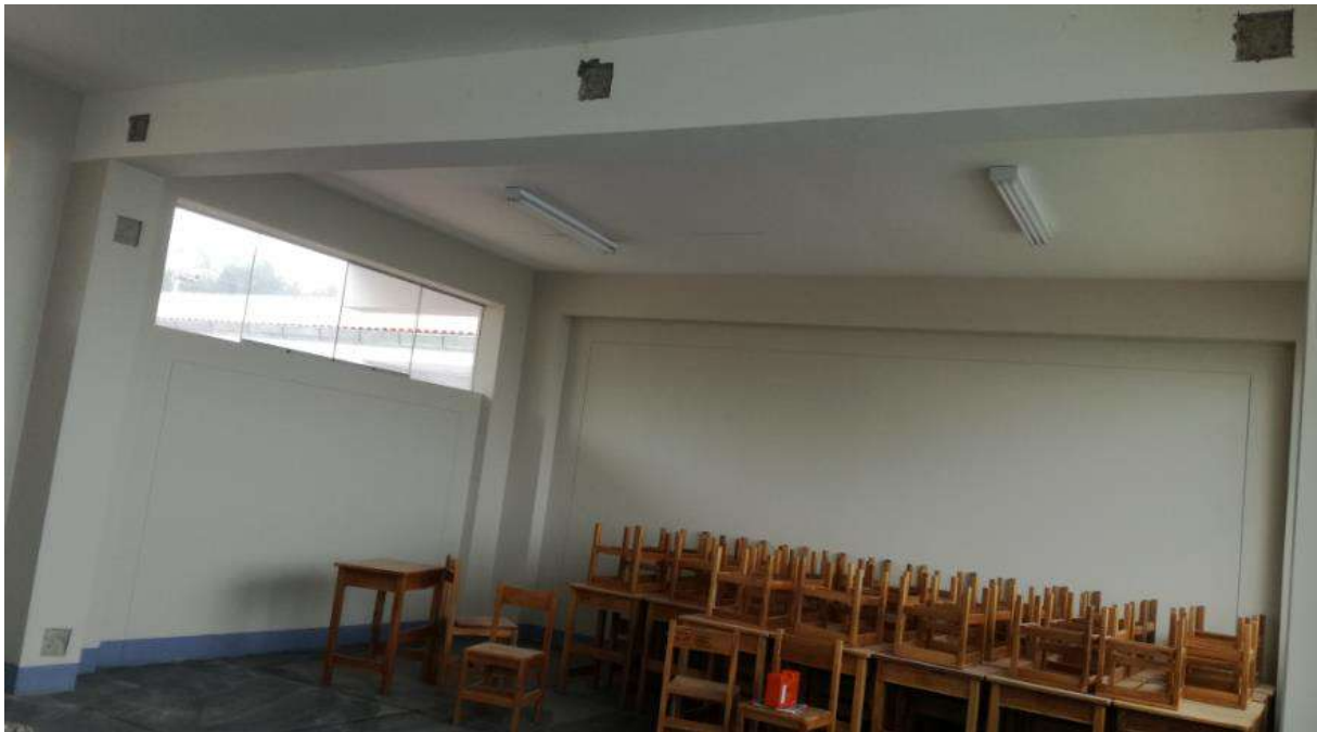
Fotografía 15 y 16: Ensayo de esclerometría en vigas y columnas en el módulo 02, tercer nivel
