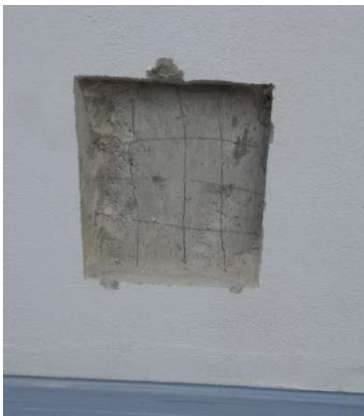
Fotografía 19 y 20: Cuadrícula de 4x4 cm de lado, en cada cuadrícula se realizó una lectura. Impacto sobre la superficie con el esclerómetro en forma perpendicular.
