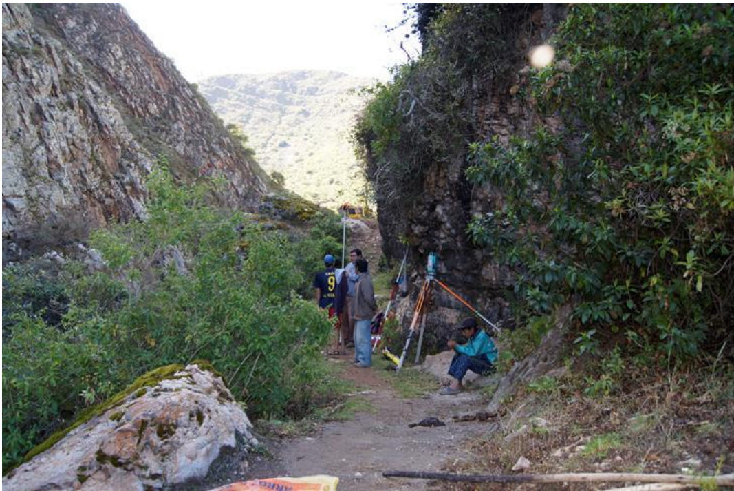
Figura 44. Levantamiento topográfico de la boquilla.
