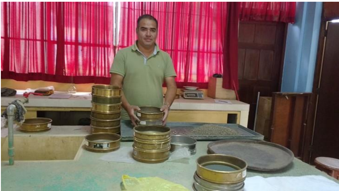
Figura 65. Tamizado del material de río en laboratorio de suelos para análisis granulométrico.
