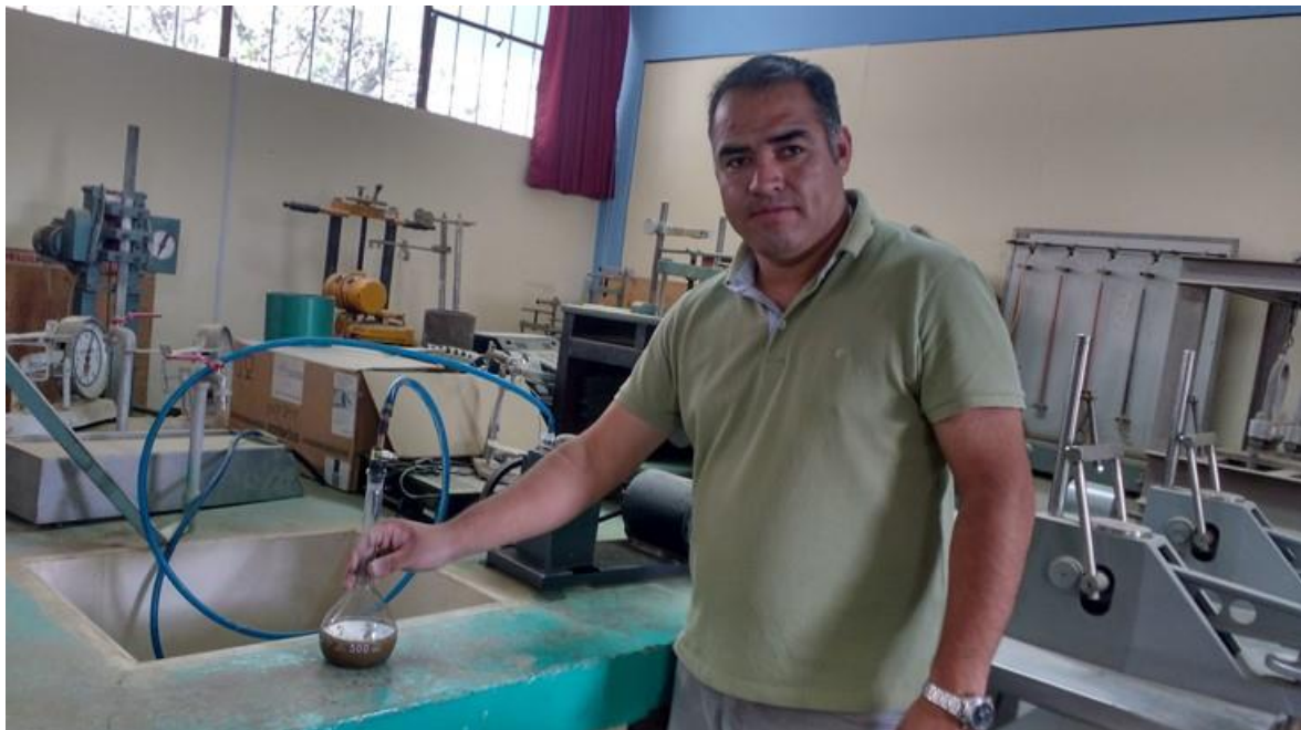
Figura 67. Ensayo de peso específico de material fino.
