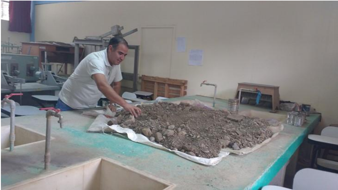
Figura 64. Secado del material de río en laboratorio de suelos para análisis granulométrico.
