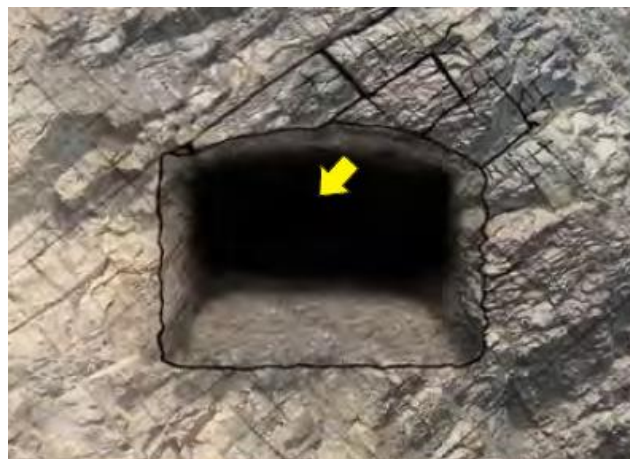
Figura 11. Bloques irregulares liberados por las intersecciones de las diaclasas en rocas fracturadas. Fuente: SNMPE, 2004.
