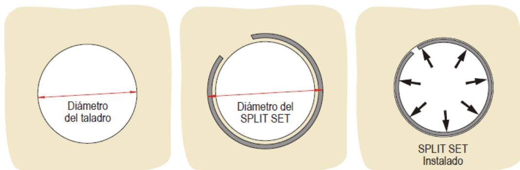
Figura 19. Mecanismo de anclaje del Split Set. Fuente: SNMPE, 2004.
