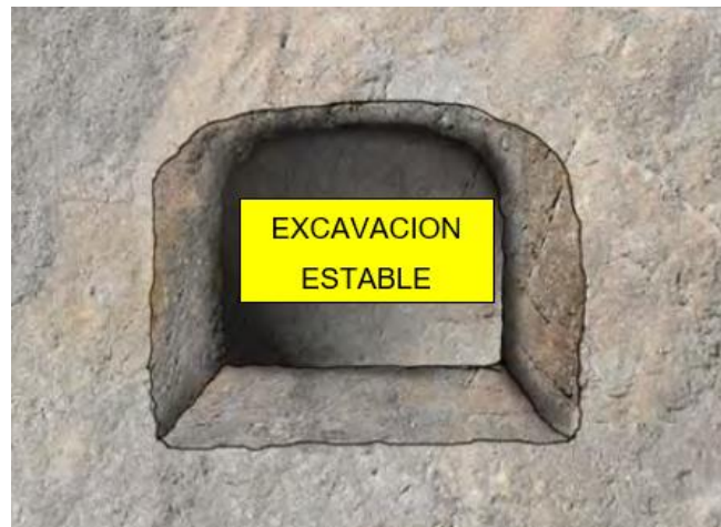
Figura 7. Ejemplo de una excavación en roca masiva con pocas fracturas. Fuente: SNMPE, 2004.
