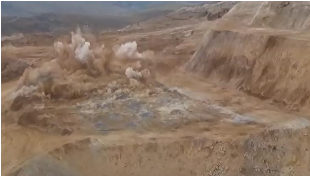
Foto 10. Proceso del disparo. El análisis del video del disparo es importante para el control en voladura de rocas; nos permite identificar posibles tiros quedados, eyección de rocas y presencia de humos nitrosos (humos naranjas ( \text{NO}_{2,3} )) por un inadecuado balance de oxígeno en la mezcla explosiva. Inicio de la detonación.
