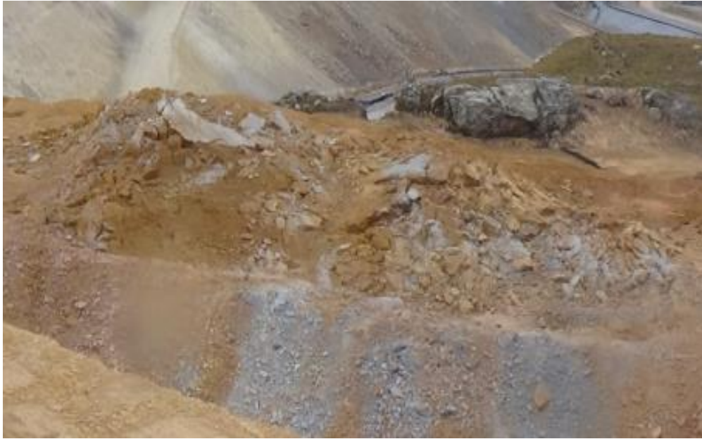
Foto 15. Esponjamiento post voladura. En la imagen se muestra buen esponjamiento del material.
