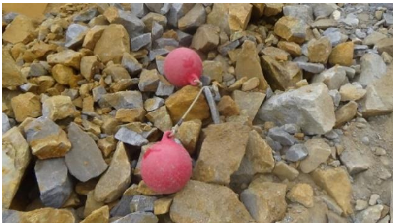
Foto 16. Fotografías para el análisis granulométrico. Diámetro de las esferas es 9.8 pulgadas. Las fotos a) y b) muestra la granulometría del material volado.
