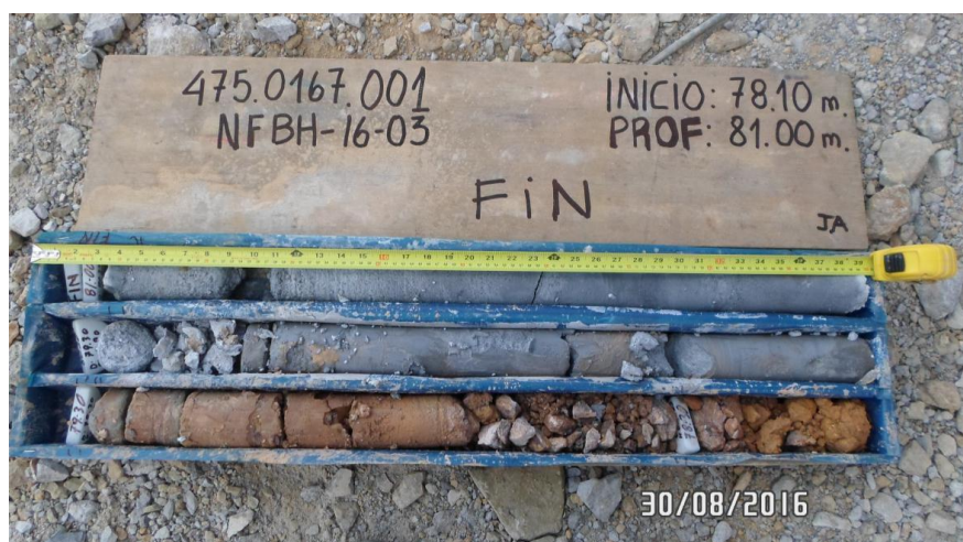
Foto 8. Caja de logueo conteniendo las muestras entre los 78.10 y 81.00 m de profundidad (Reporte Interno Geotecnia MYSRL, 2016).
