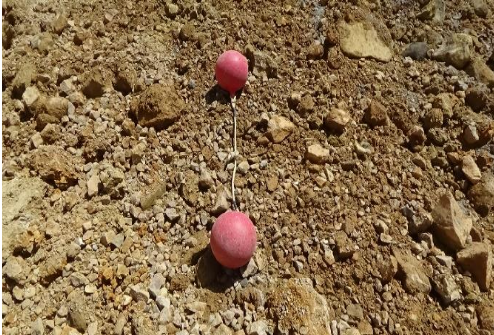
Foto 19. Granulometría post voladura prueba realizada 21/11/2017. Diámetro de las esferas es 9.8 pulgadas. Se observa pequeños bloques de roca.
