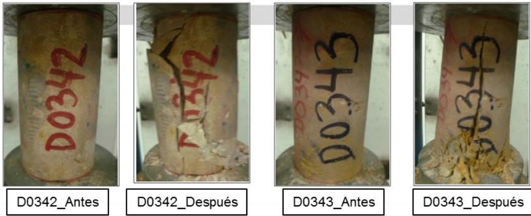
Foto 4. Imagen de la prueba de resistencia a la compresión uniaxial a las muestras de la sílice masiva (Reporte Interno Geotecnia MYSRL, 2016).
