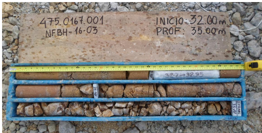
Foto 7. Caja de logueo conteniendo las muestras entre los 32.00 y 35.00 m de profundidad (Reporte Interno Geotecnia MYSRL, 2016).
