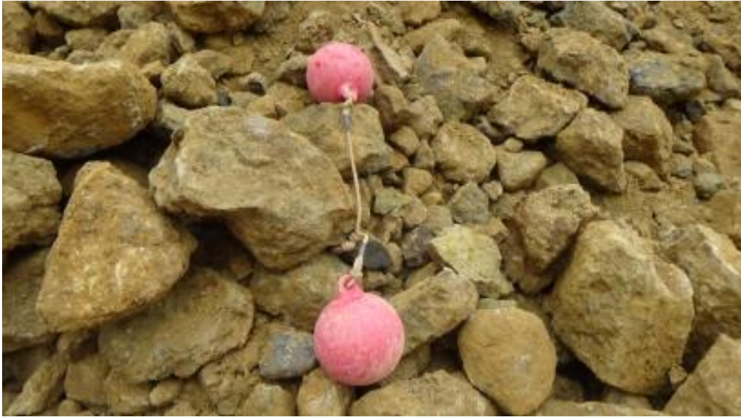
Foto 17. Granulometría post voladura prueba realizada 14/11/2017. Diámetro de las esferas es 9.8 pulgadas. Se observa grandes bloques de roca.
