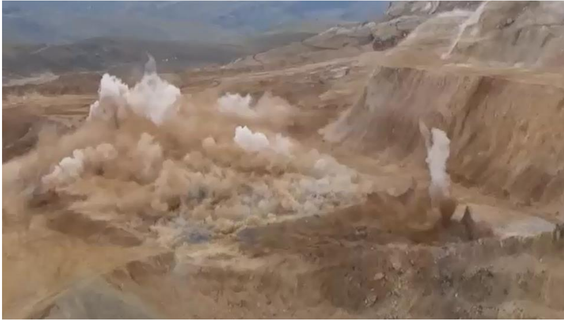
Foto 11. Proceso del disparo. El análisis del video del disparo es importante para el control en voladura de rocas; nos permite identificar posibles tiros quedados, eyección de rocas y presencia de humos nitrosos (humos naranjas ( \text{NO}_{2,3} )) por un inadecuado balance de oxígeno en la mezcla explosiva. Fin de la detonación. No se observa presencia de flyrock ni humos tóxicos.
