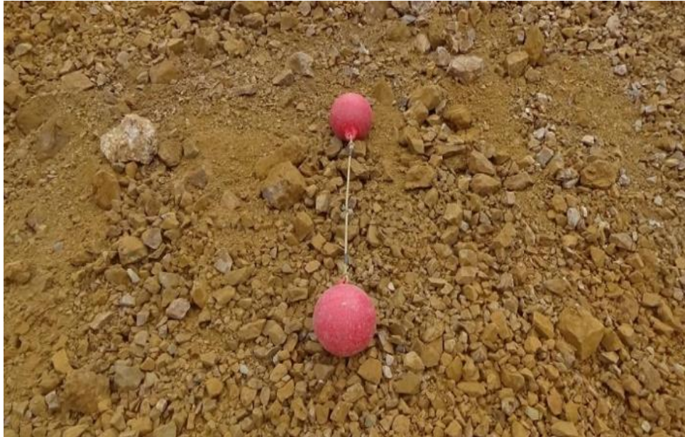
Foto 18. Granulometría post voladura prueba realizada 15/11/2017. Diámetro de las esferas es 9.8 pulgadas. Se observa pequeños bloques de roca y presencia de zonas con material fino.
