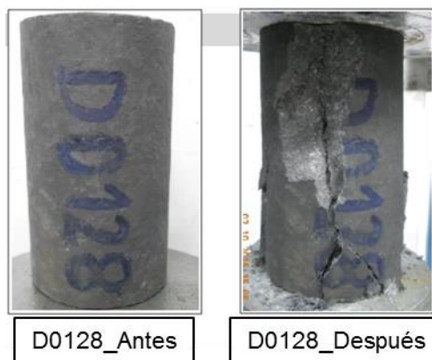
Foto 3. Imagen de la prueba de resistencia a la compresión uniaxial a las muestras de la alteración Propilítica (Reporte Interno Geotecnia MYSRL, 2016).
