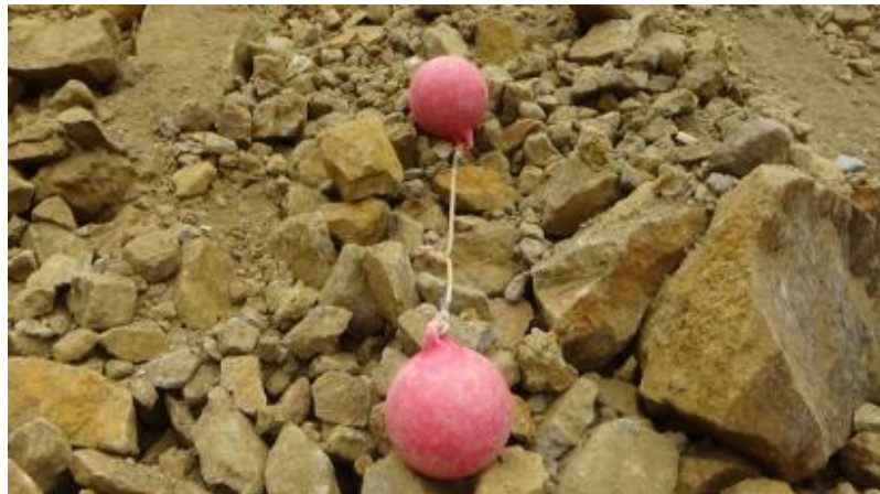
Foto 15. Esponjamiento post voladura. En la imagen se muestra buen esponjamiento del material.
