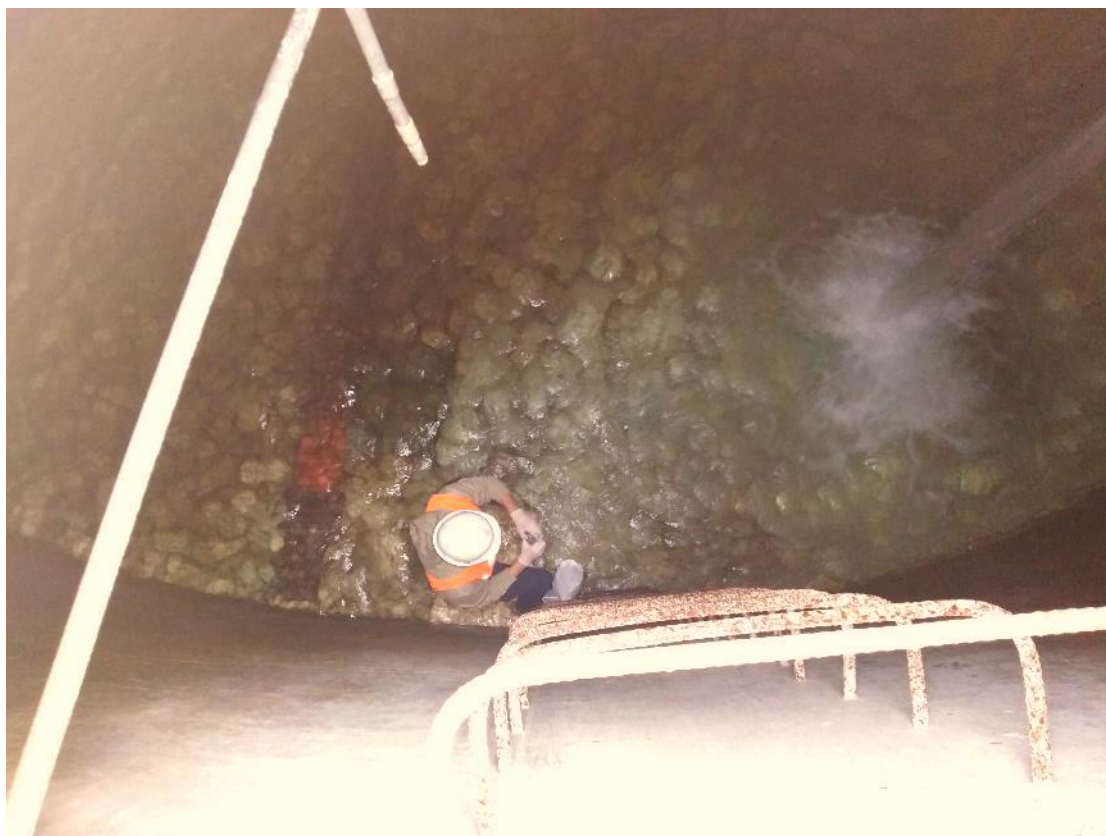
Figura 21. Toma de muestra de agua para análisis de Dureza Total en entrada a Reservorio.
