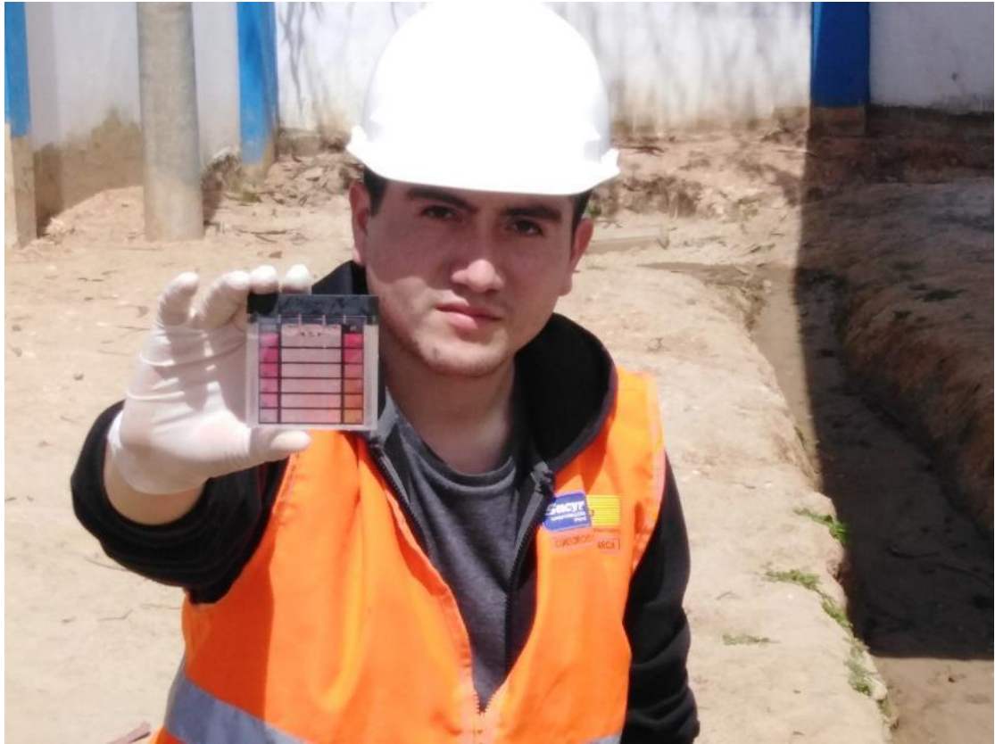
Figura 16. Medición de Cloro Libre Residual en la entrada de la PTAP.
