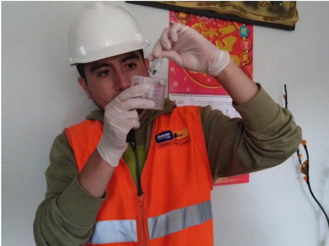
Figura 25. Medición de Cloro Libre Residual en conexión domiciliaria.
