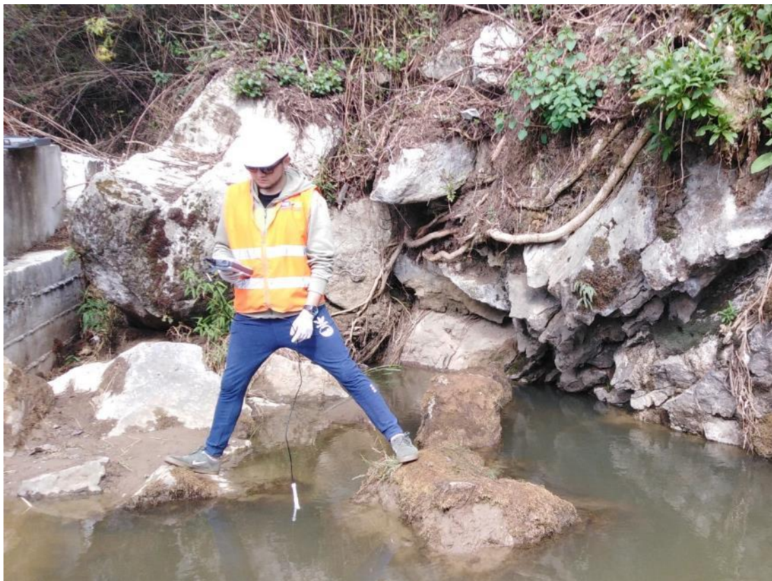
Figura 23. Toma de Conductividad Eléctrica usando el multiparámetro.
