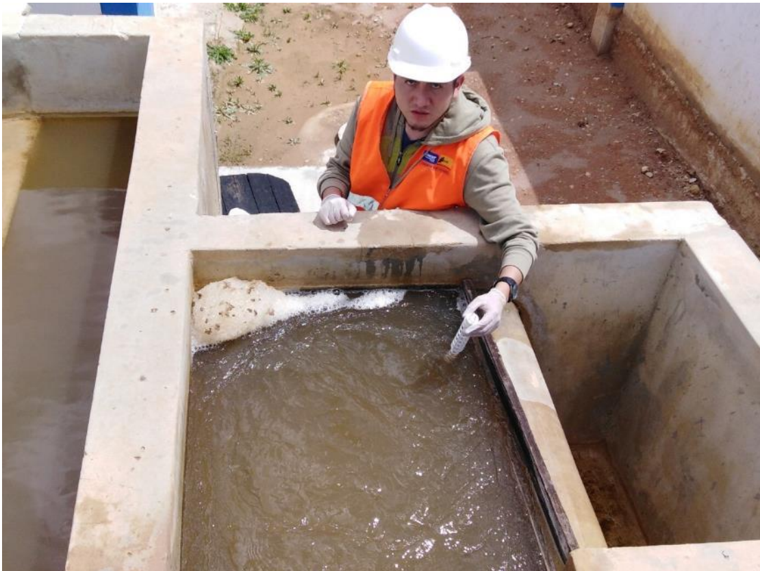
Figura 27. Medición de Temperatura en la entrada de agua a la PTAP.
