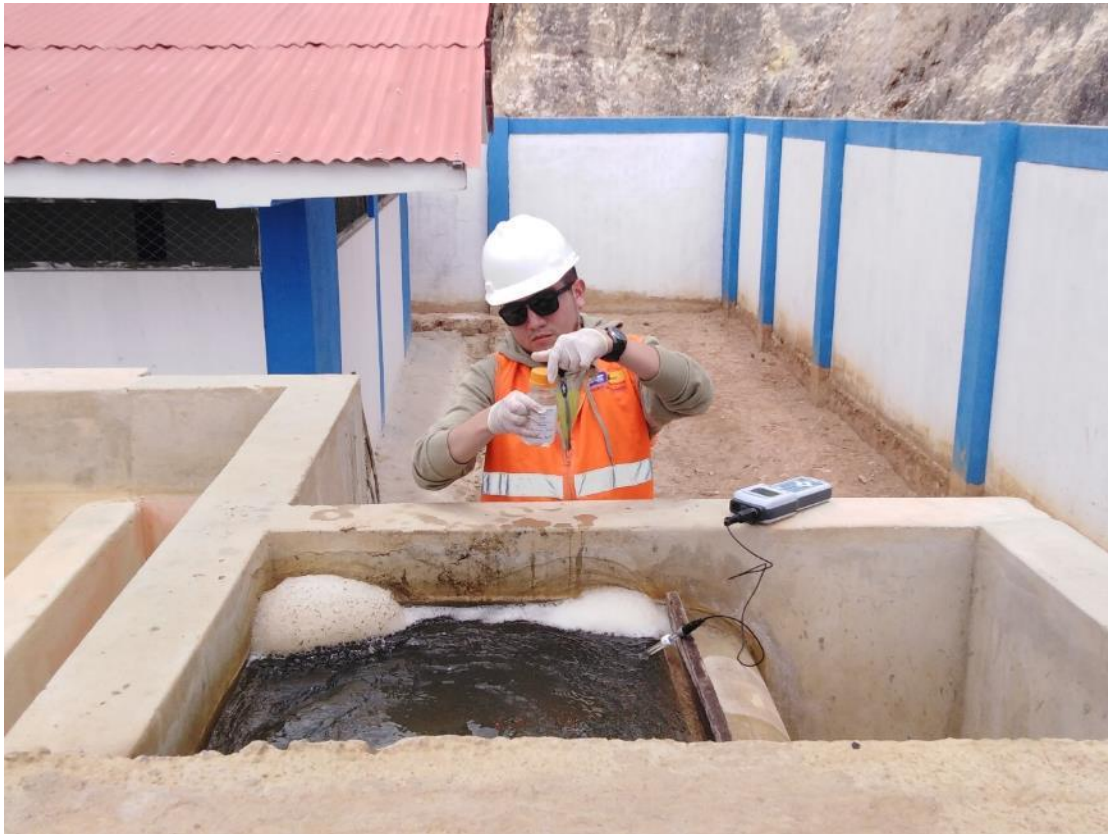
Figura 24. Toma de muestra de agua para análisis de Colif. Tot. y Termotolerantes.
