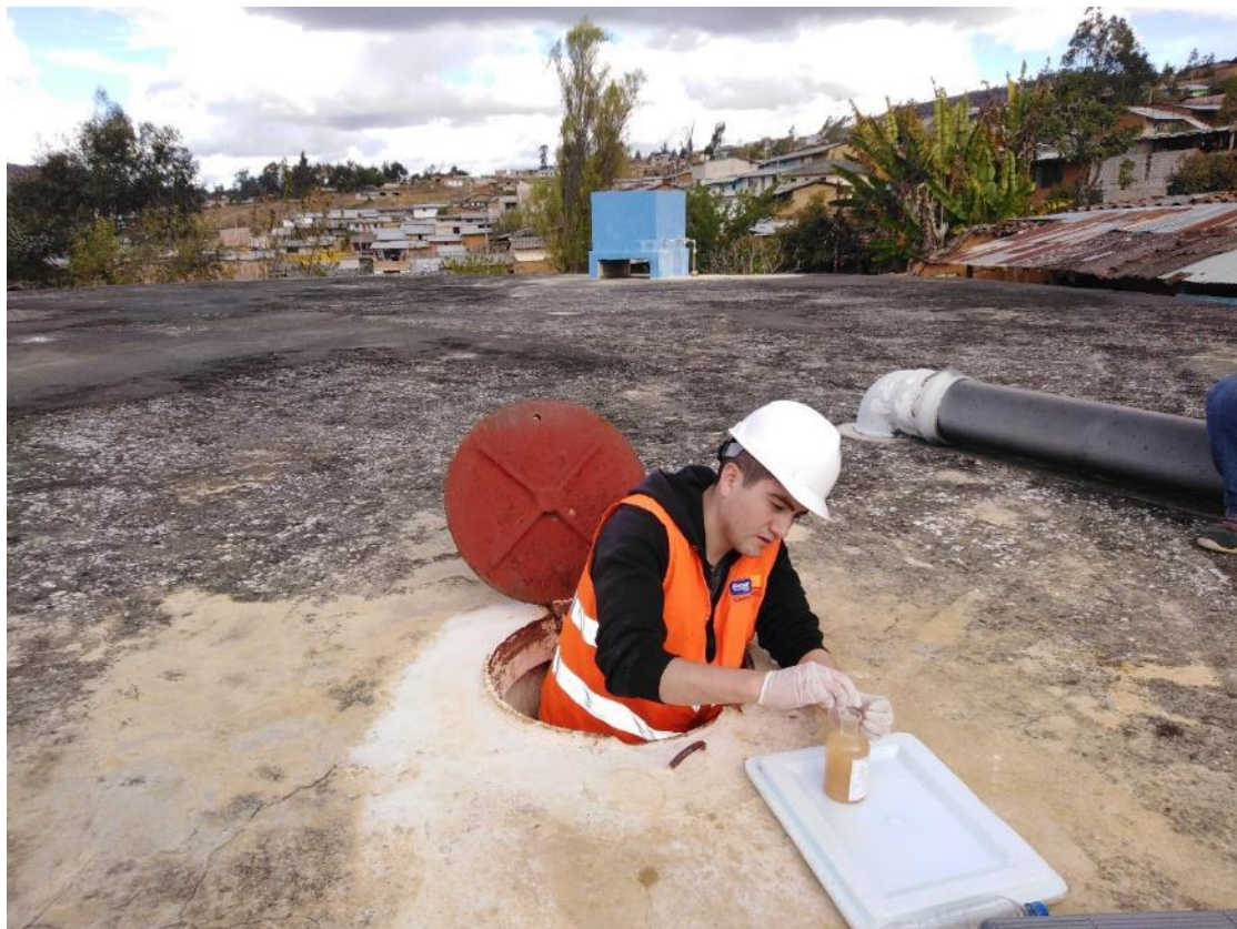
Figura 17. Adición de reactivos para la preservación de Oxígeno Disuelto.
