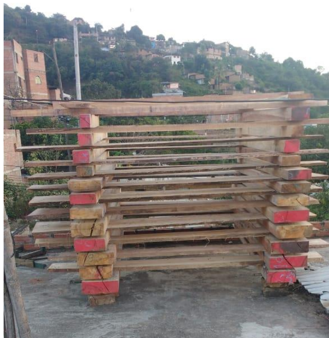
Foto 10. Secado natural de la madera aserrada
