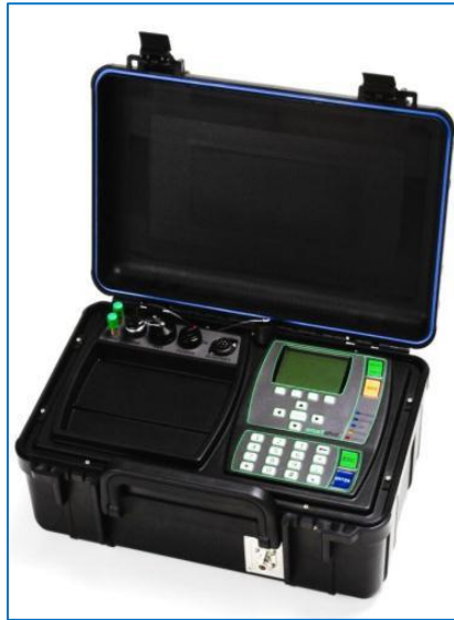
Figura 09. Equipo de disparo, Base Station.
