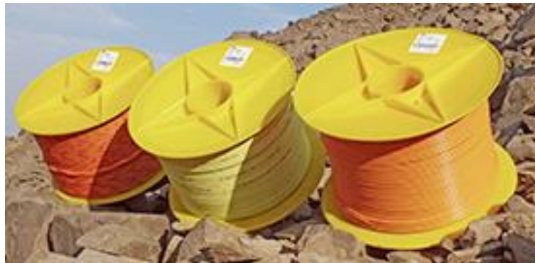
Figura 05. Cordón detonante envuelto en carretes.
