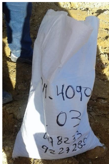
Foto 08. Recojo de material excavado con un peso de 25 kg que posteriormente fue llevado al laboratorio de geotécnica de Minera Yanacocha para su análisis granulométrico, además se incluía en la bolsa un etiquetado del nivel correspondiente (QM 4090), número de muestra (C-03) y coordenadas GPS - Tajo Quecher Main.
