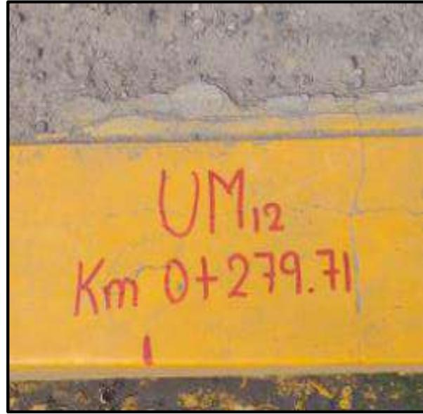
*Imagen 4. Marcado de progresivas y unidades de muestreo de las secciones*
