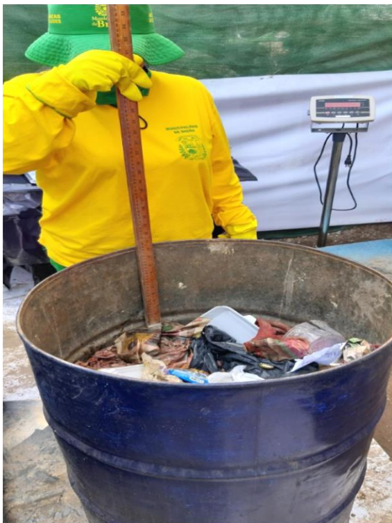
Altura del cilindro para hallar la densidad de los residuos solidos
