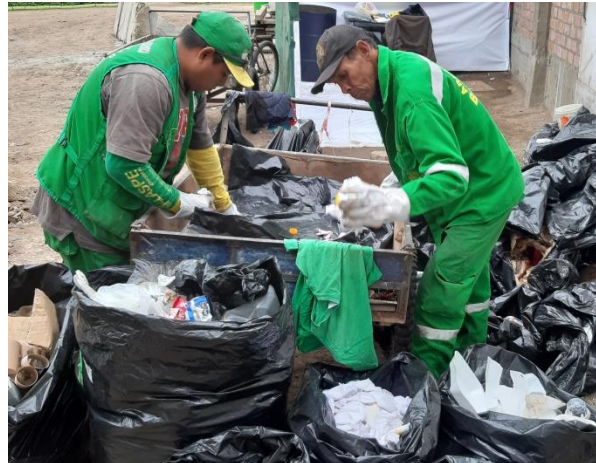
Separación de los residuos sólidos para determinar la composición
